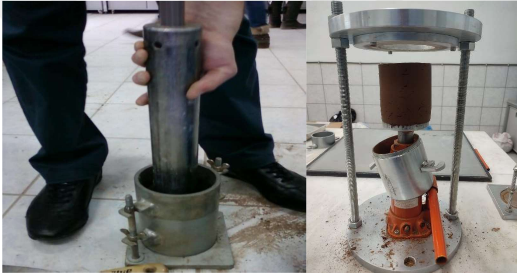
Şekil 3.7. Kompaksiyon deneyi sırasında sıkıştırma işlemi ve sıkıştırılmış numunenin kalıptan kriko yardımıyla çıkarılması
