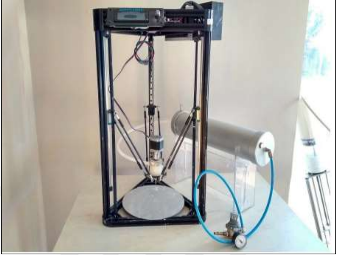
Şekil 2.2. Jonathan Keep tarafından geliştirilen 3B seramik yazıcı (Keep, 2024)
