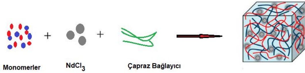
Şekil 2.2. Polimer/Nd hidrojel kompozitinin hazırlanması
