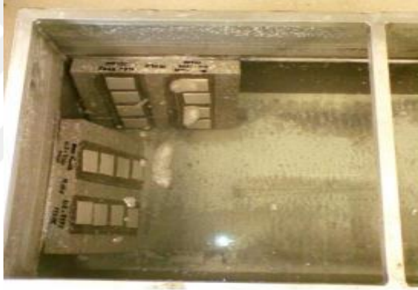
Şekil 1. 34 Islak şartlandırma için seramiklerin su havuzundaki gösterimi
