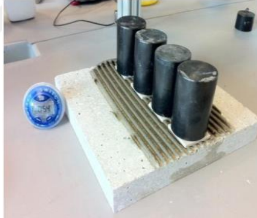
Şekil 1. 32 Harç betona taraklandıktan sonra seramiklerin ağırlıklarla sabit tutulması
