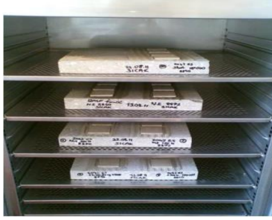
Şekil 1. 33 Sıcak şartlandırma için seramiklerin etüvdeki gösterimi
