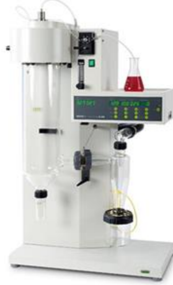
Şekil 1. 30 Sıvı polimeri toz partiküle dönüştürmeye yarayan Buchi B-290 cihaz
