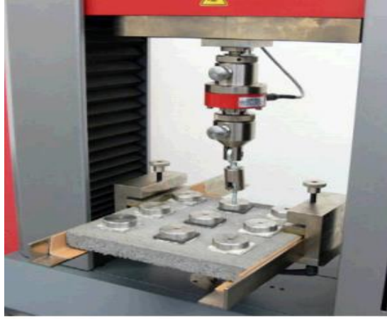
Şekil 1. 35 Seramiklerin cihaza yerleştirilmesi ve test aşaması
