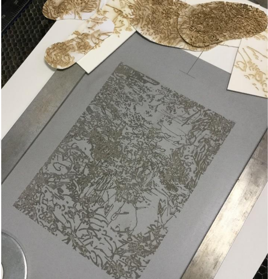
Resim 9. Lazer Uygulaması ile Üretilmiş Litografi Plakası ( www.freefall-laser.com , 2024)
