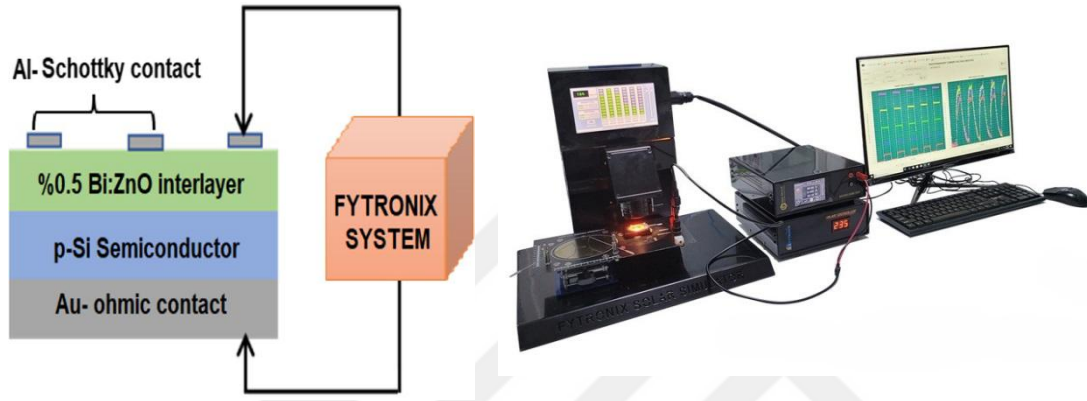
Şekil 3.1 (a,b). Hazırlanan Al/(Bi:ZnO)/p-Si/Au MIS tipi Schottky diyotun şematik görseli ve Kapasitans-voltaj (C-V) ve kondüktans/iletkenlik-voltaj ( G/\omega -V) ölçüm sistemi
