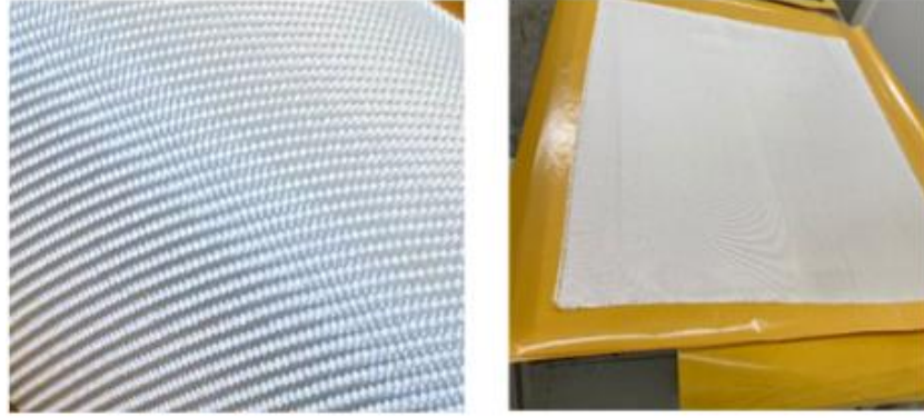
Şekil 6.4 Fiber kumaş a) Örgü biçimi b)1000 x 1000 mm 2 kumaş
