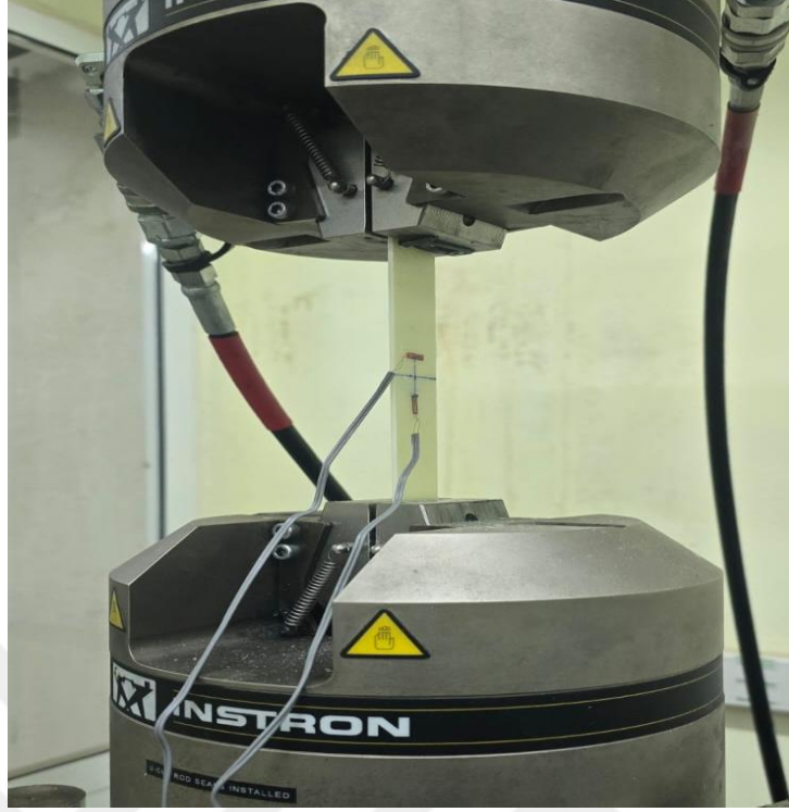
Şekil 6.9 Instron marka test cihazı ve çekme testinin yapılışı
