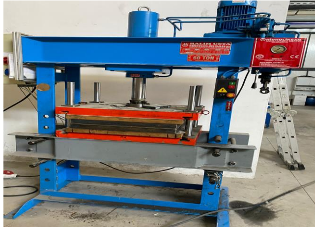
Şekil 6.6 üst üste konulmuş plakalara sıcak presleme uygulanması
