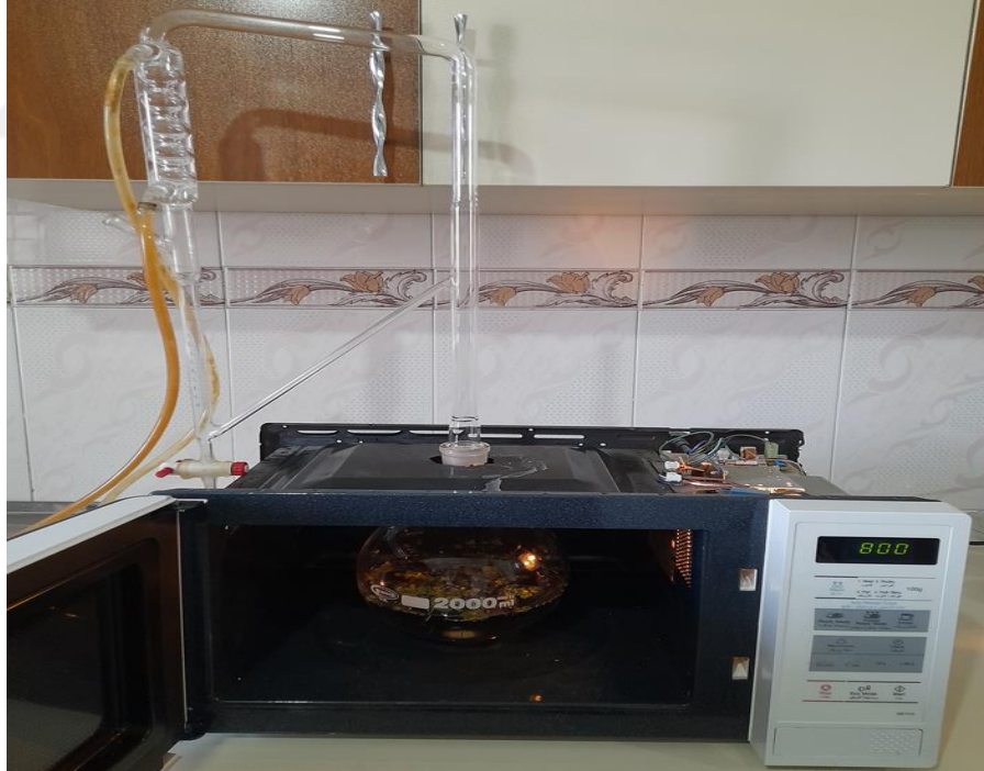
Şekil 5. Uçucu yağ elde etmede kullanılan mikrodalga damıtma sistemi
