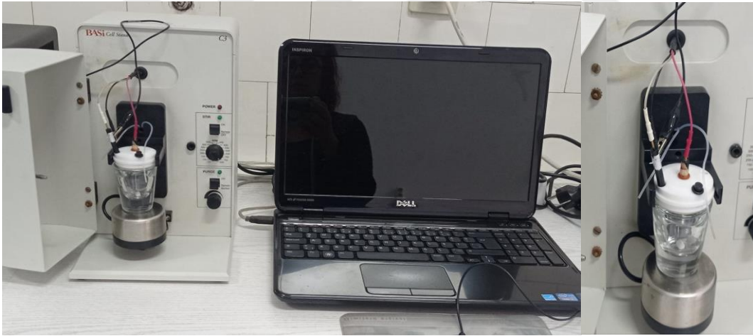
Şekil 3.3: Elektrotların empedans ölçümü ve potansiyel-zaman (E-t) eğrilerinin elde edilmesi için kullanılan CHI 660D marka elektrokimyasal analiz sistemi ve BASi C3 hücre standı.
