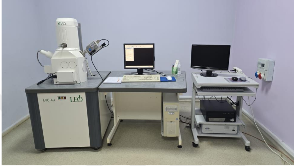
Şekil 3.4: LEO Marka EVO 40 Model taramalı elektron mikroskobu.
