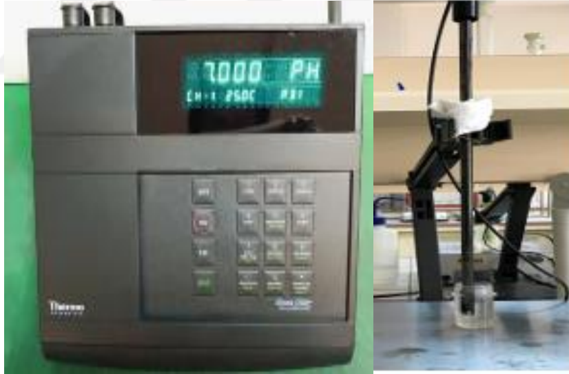
Şekil 3.1: pH ölçümleri için kullanılan Orion 720A Model pH-iyon metre ve Thermo Orion 812600 kombine cam elektrot.
