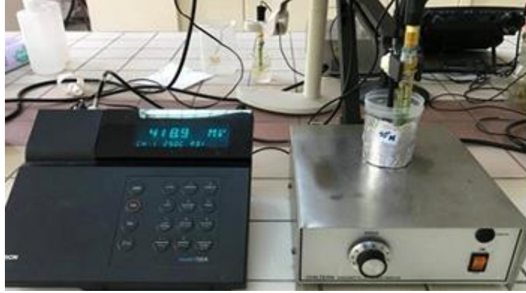
Şekil 3.2: Potansiyometrik ölçümler için kullanılan Orion 720A Model pH-iyon metre, Chiltern MS212S Model manyetik karıştırıcı, Ag/AgCl referans elektrot ve tiyosiyanat-seçici karbon pasta elektrottan (indikatör elektrot) oluşan deney düzeneği.
