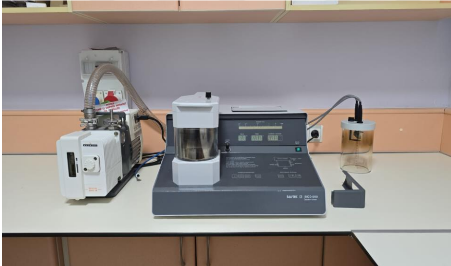
Şekil 3.5: Numunelerin iletken malzeme ile kaplanması için kullanılan sputter kaplama cihazı.
