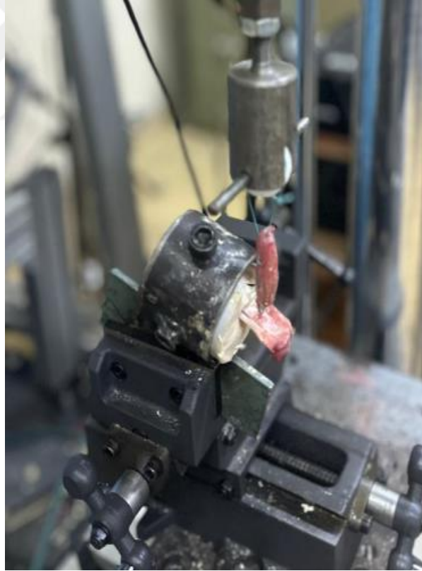
Şekil 29: Kemik-tendon-kas kompleksi ile hazırlanan biyomekanik test düzeneği görselleri.
