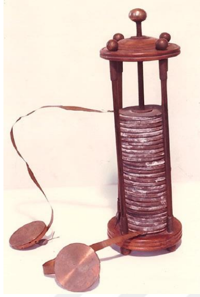
Şekil 2.1: Alessandro Volta pili (Scrosati, 2011).
