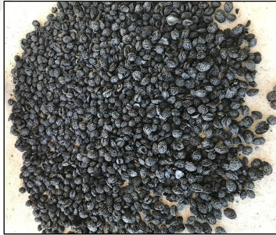
Şekil 3.7. Elektriksel güç kaynaklı pirolizerde üretilen şeftali çekirdeği biyokömürü
