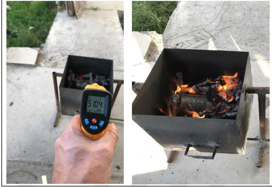
Şekil 3.14. Retort pirolizerden sıcaklık ölçümü
