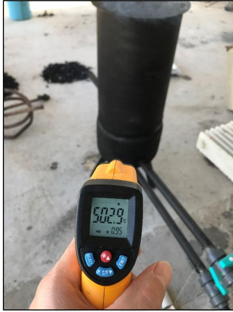
Şekil 3.10. Atık madeni yağ ile çalışan pirolizerden sıcaklık ölçümü
