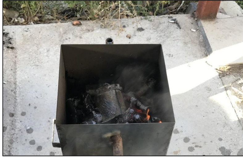
Şekil 3.15. Retort pirolizer ile üretilen biyokömür üretimi
