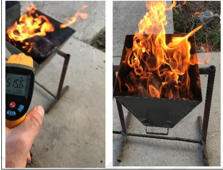
Şekil 3.3. Kon-tiki pirolizerin tamamlanmış hali ve çalışırken sıcaklık ölçümü
