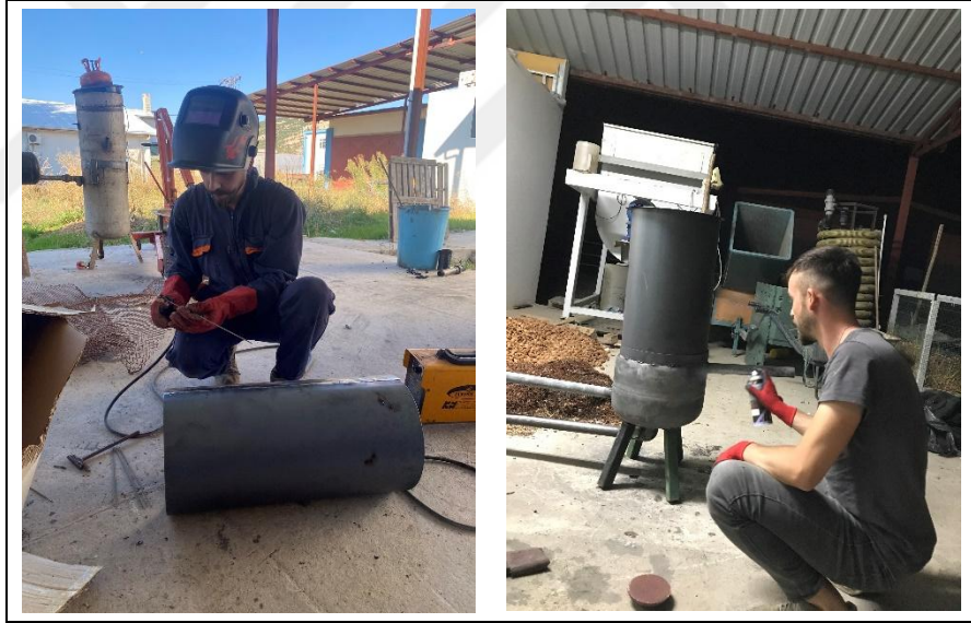
Şekil 3.9. Atık madeni yağ ile çalışan pirolizer imalatı
