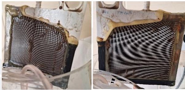
Şekil 45. Modülün reaktöre daldırılması sonucu oluşan modül fotoğrafı.
