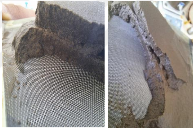
Şekil 40. SÇ çamuru ile modül üzerinde oluşan tabaka görüntüsü
