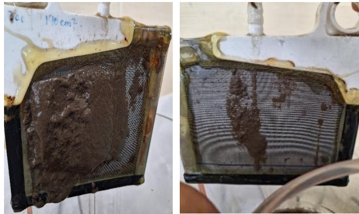
Şekil 46. 49 saat sonunda sistem kapatıldığındaki modül fotoğrafı
