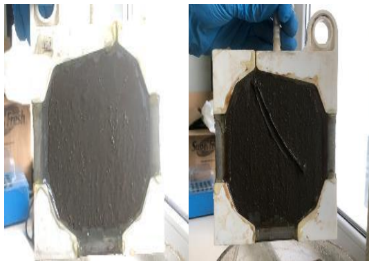
Şekil 17. 150 µm elek Besleme yapıldıktan sonra modül fotoğrafı
