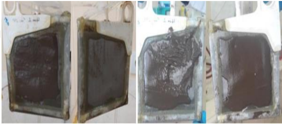
Şekil 100. DMBR’de oluşan kek tabakası (solda ilk iki fotoğraf), YÇ-DMBR’de oluşan kek tabakası (sağdaki iki fotoğraf).
