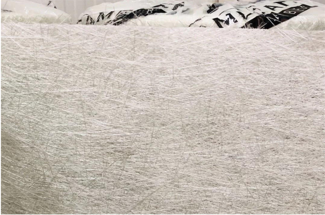
Şekil 3.2. Şişecam E-mat 450g/m 2 Cam Elyaf keçe.
