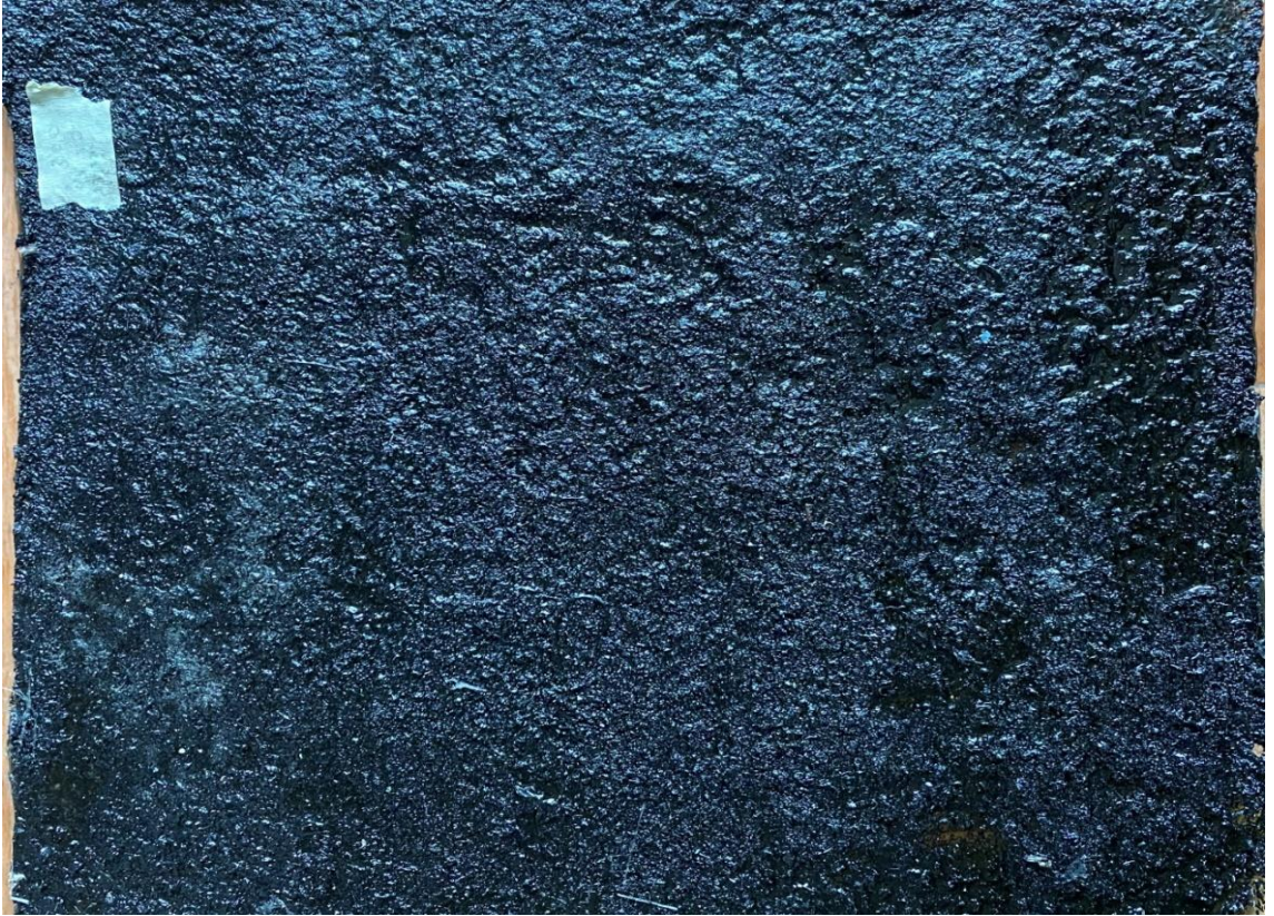
Şekil 5.5. %27 atık lastik tozu içeren kompozit
