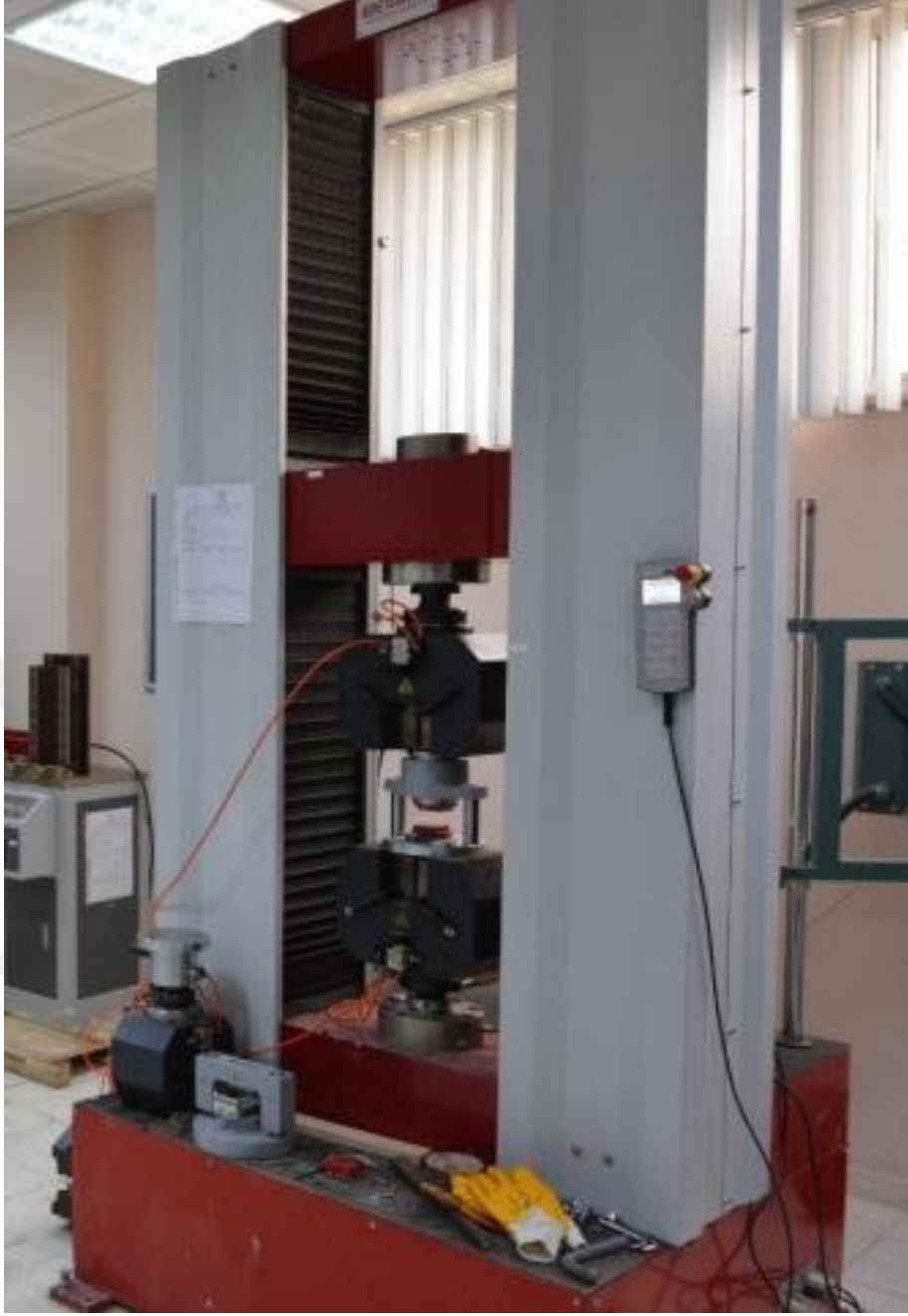
Şekil 5.9. Çekme Basma Eğilme test cihazı
