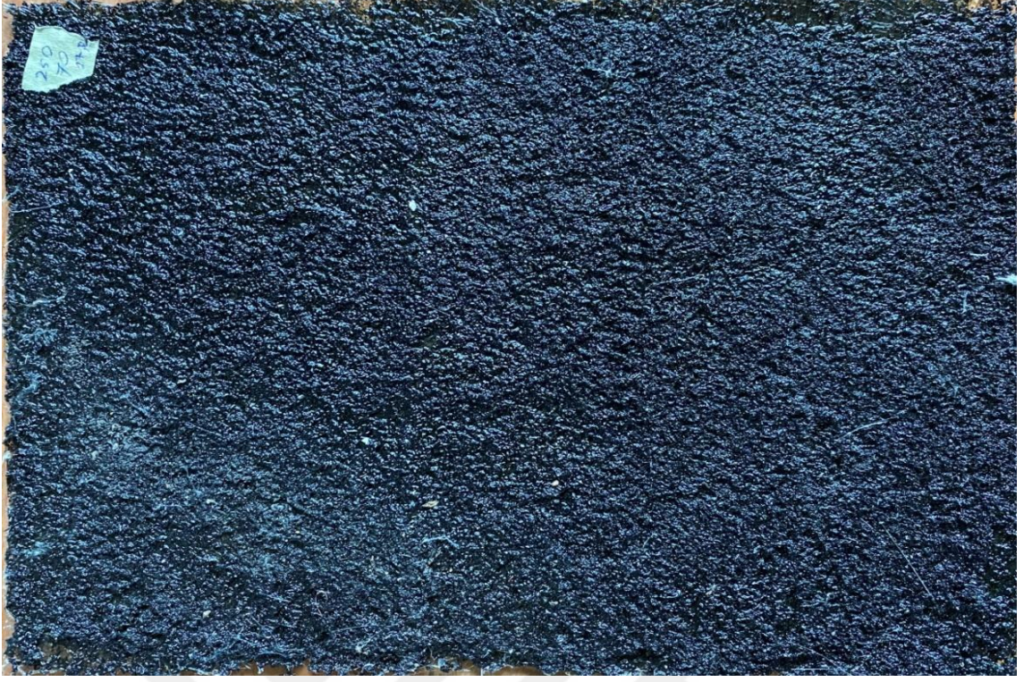
Şekil 5.4. %23 atık lastik tozu içeren kompozit
