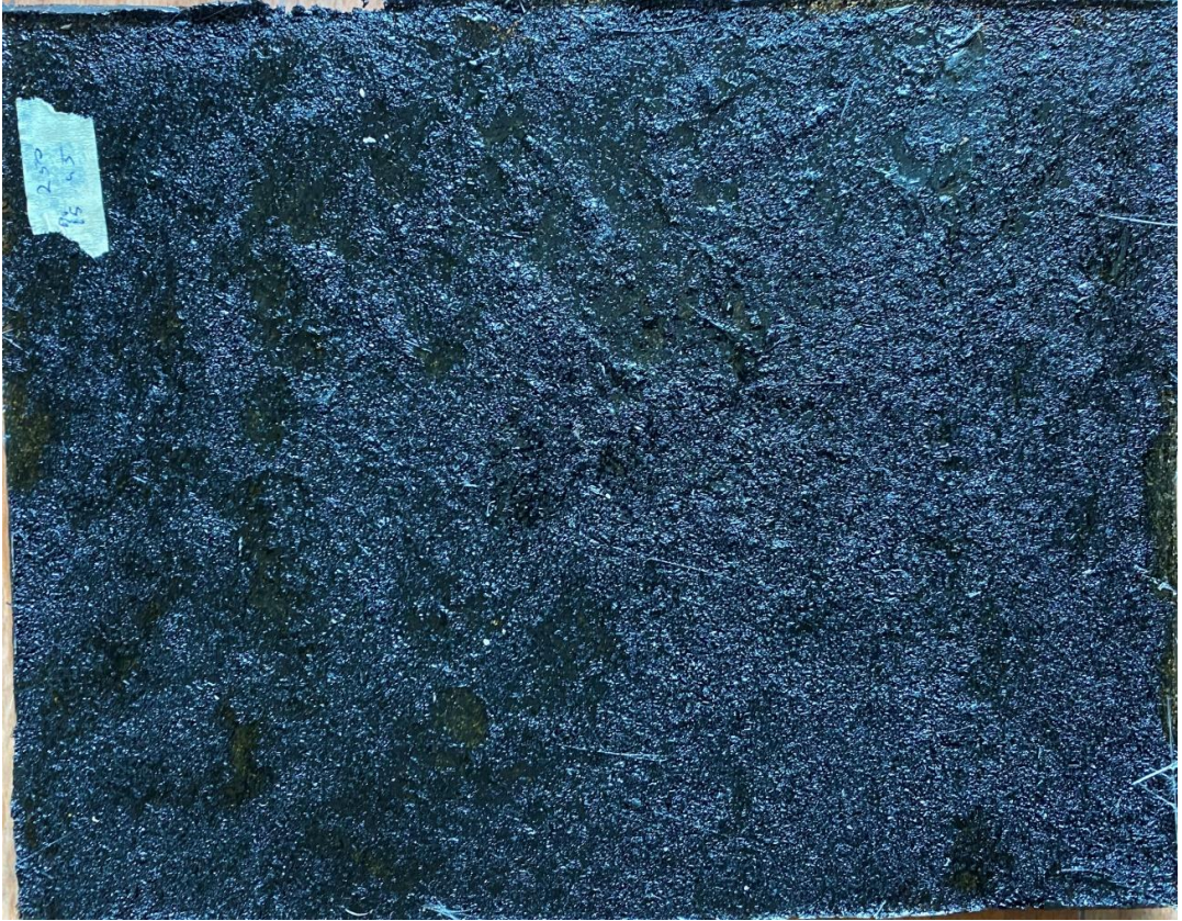
Şekil 5.3. %15 atık lastik tozu içeren kompozit
