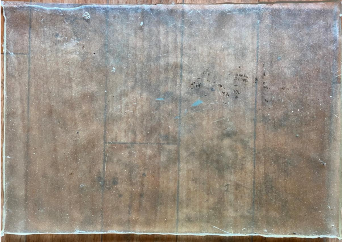
Şekil 5.1. %0 atık lastik tozu içeren kompozit
