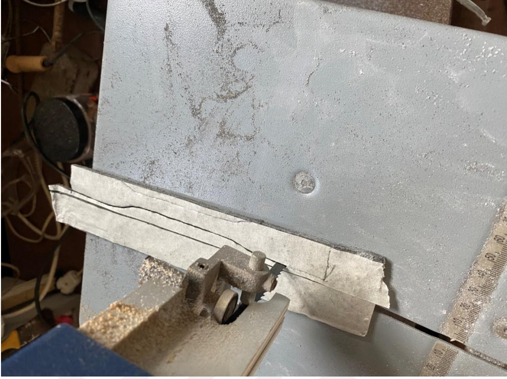
Şekil 5.7. Numunelerin standartlara uygun hale kesilmesi
