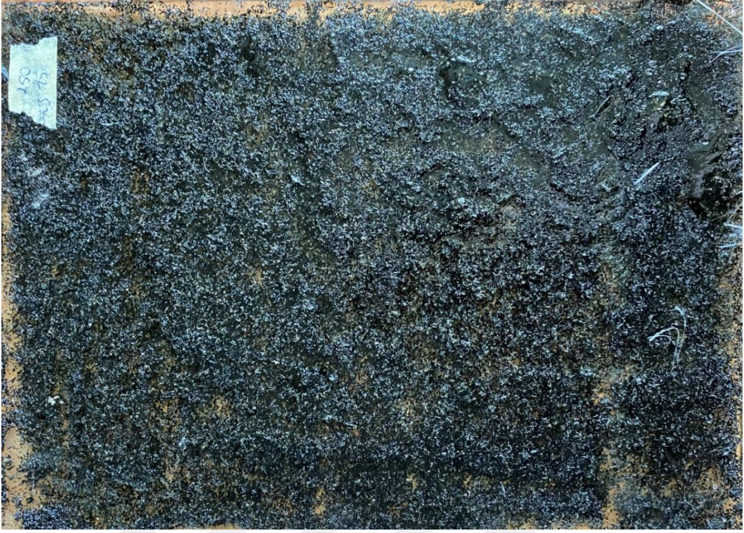
Şekil 5.2. %10 atık lastik tozu içeren kompozit
