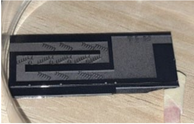
Görsel 3. 4: Silikon yapılı \mu GC sistem görseli.
