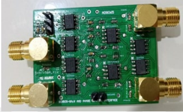
Görsel 4.1: \mu IDE sensör ve prototip uygulaması arayüz devre PCB görseli.
