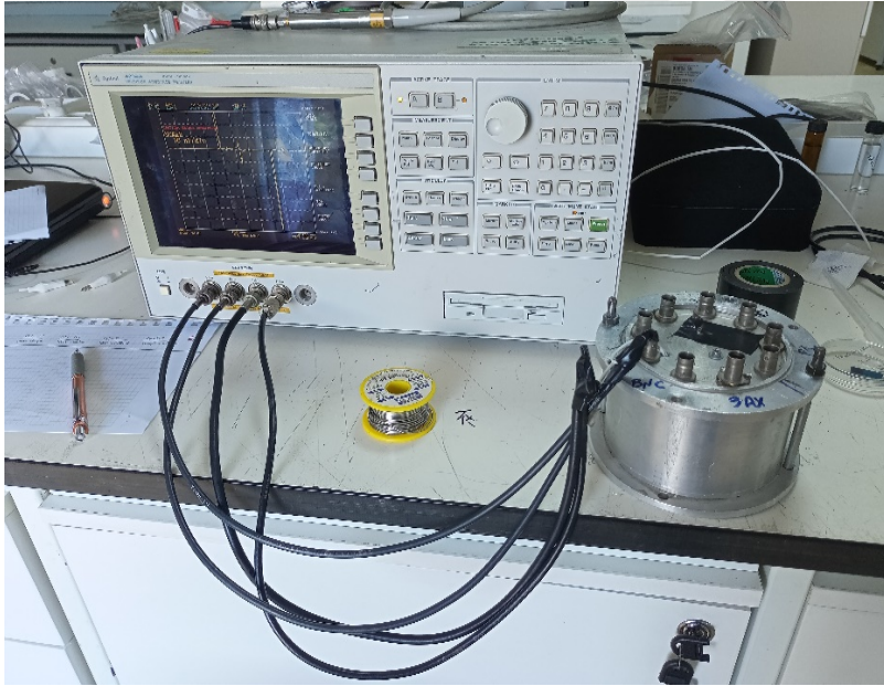
Şekil 3.2: Sensörün empedans analizörü gaz tepkisinin ölçüm düzeneği.
