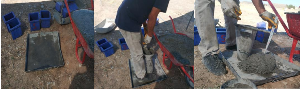
Şekil 2.50: Slump (Çökme) Testi
