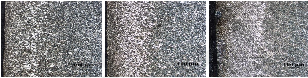
(a) (b) (c) Şekil 6.9. 1000 °C’de 2 saat işlem görmüş numuneler (100x) a) %0 aktivatör ile b) %5 aktivatör ile c) %10 aktivatör ile
