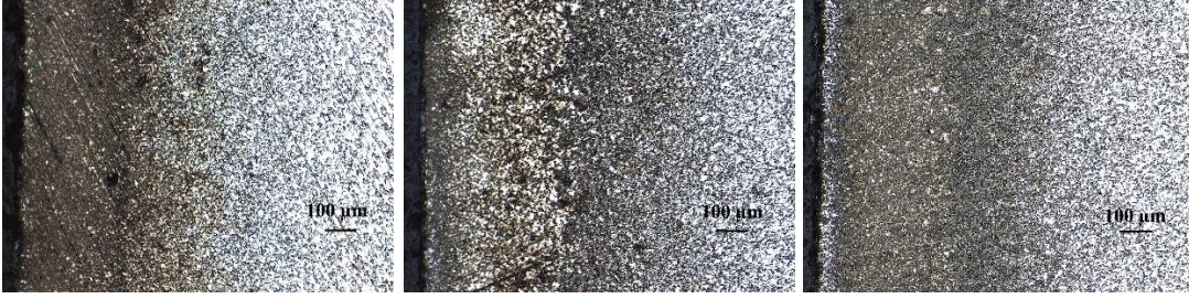
(a) (b) (c) Şekil 6.8. 1000 °C’de 1 saat işlem görmüş numuneler (100x) a) %0 aktivatör ile b) %5 aktivatör ile c) %10 aktivatör ile
