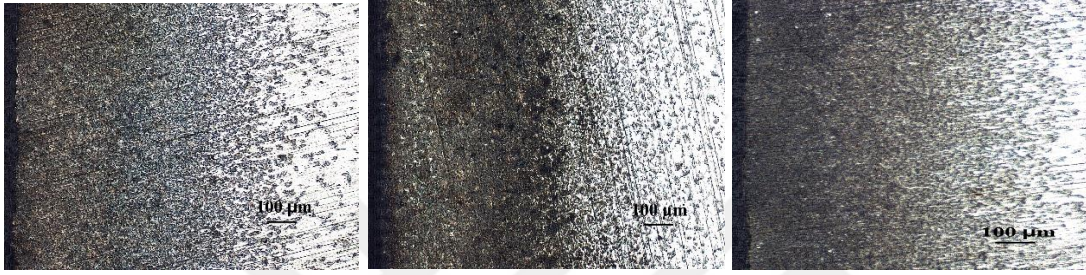
(a) (b) (c) Şekil 6.3. 900 °C’de 2 saat işlem görmüş numuneler (100x) a) %0 aktivatör ile b) %5 aktivatör ile c) %10 aktivatör ile
