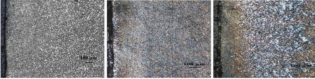
(a) (b) (c) Şekil 6.10. 1000 °C’de 4 saat işlem görmüş numuneler (100x) a) %0 aktivatör ile b) %5 aktivatör ile c) %10 aktivatör ile
