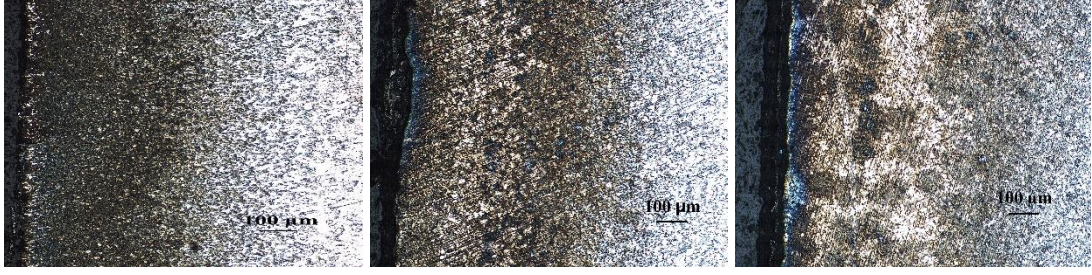
(a) (b) (c) Şekil 6.5. 950 °C'de 1 saat işlem görmüş numuneler (100x) a) %0 aktivatör ile b) %5 aktivatör ile c) %10 aktivatör ile
