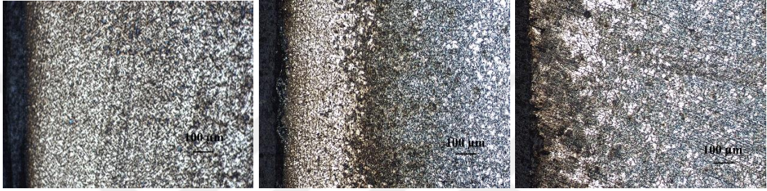
(a) (b) (c) Şekil 6.6. 950 °C'de 2 saat işlem görmüş numuneler (100x) a) %0 aktivatör ile b) %5 aktivatör ile c) %10 aktivatör ile
