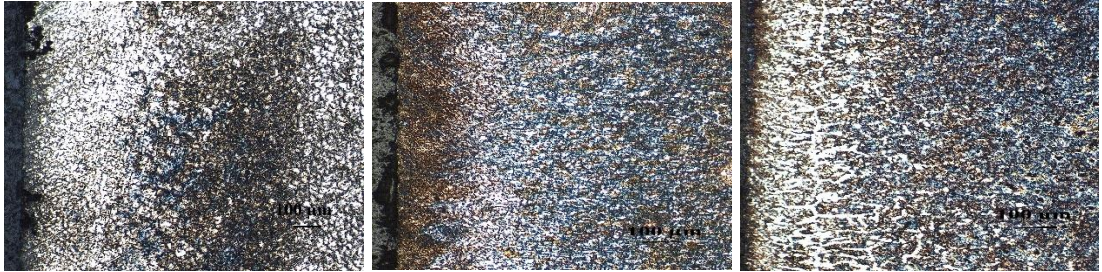
(a) (b) (c) Şekil 6.7. 950 °C'de 4 saat işlem görmüş numuneler (100x) a) %0 aktivatör ile b) %5 aktivatör ile c) %10 aktivatör ile
