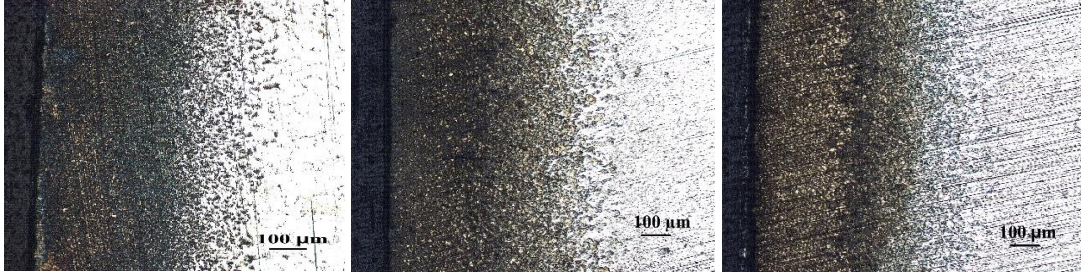
(a) (b) (c) Şekil 6.2. 900 °C’de 1 saat işlem görmüş numuneler (100x) a) %0 aktivatör ile b) %5 aktivatör ile c) %10 aktivatör ile
