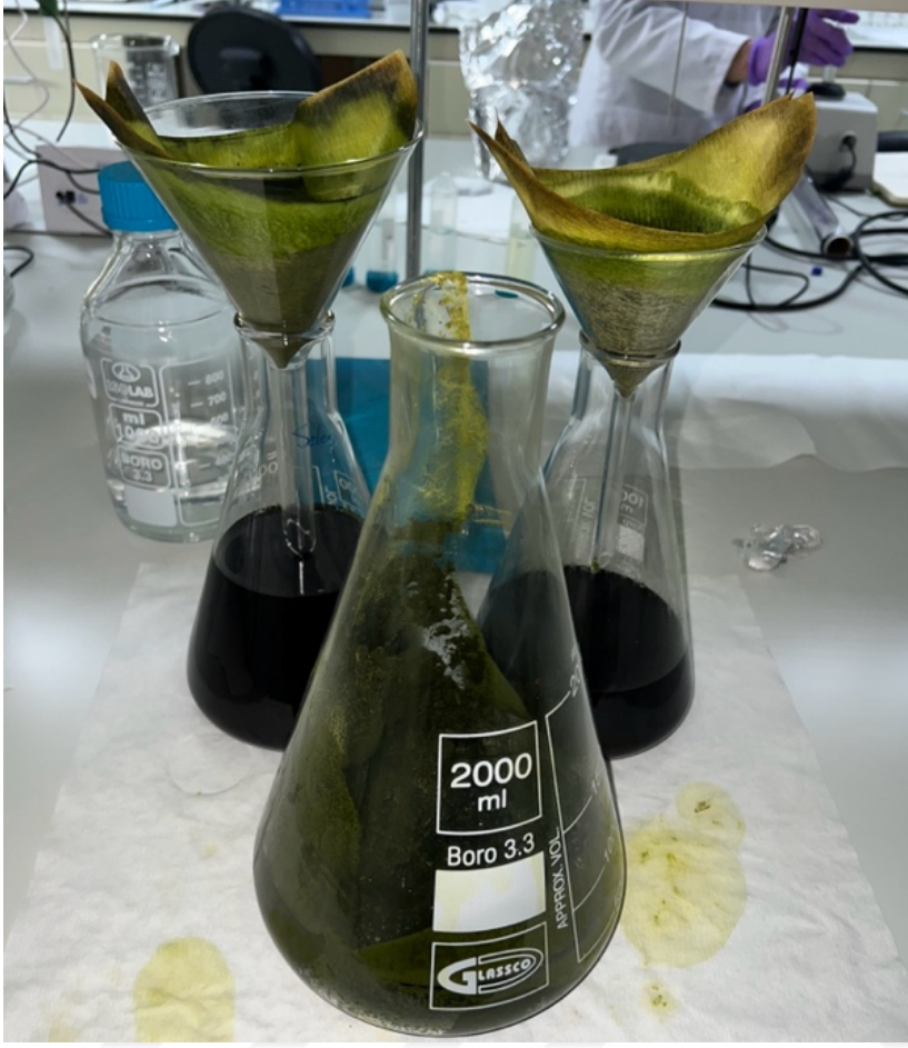
Şekil 3.10: İki katlı süzme kağıdında karadut posasının, etil alkol - su karışımından süzülerek ayrıştırılması
