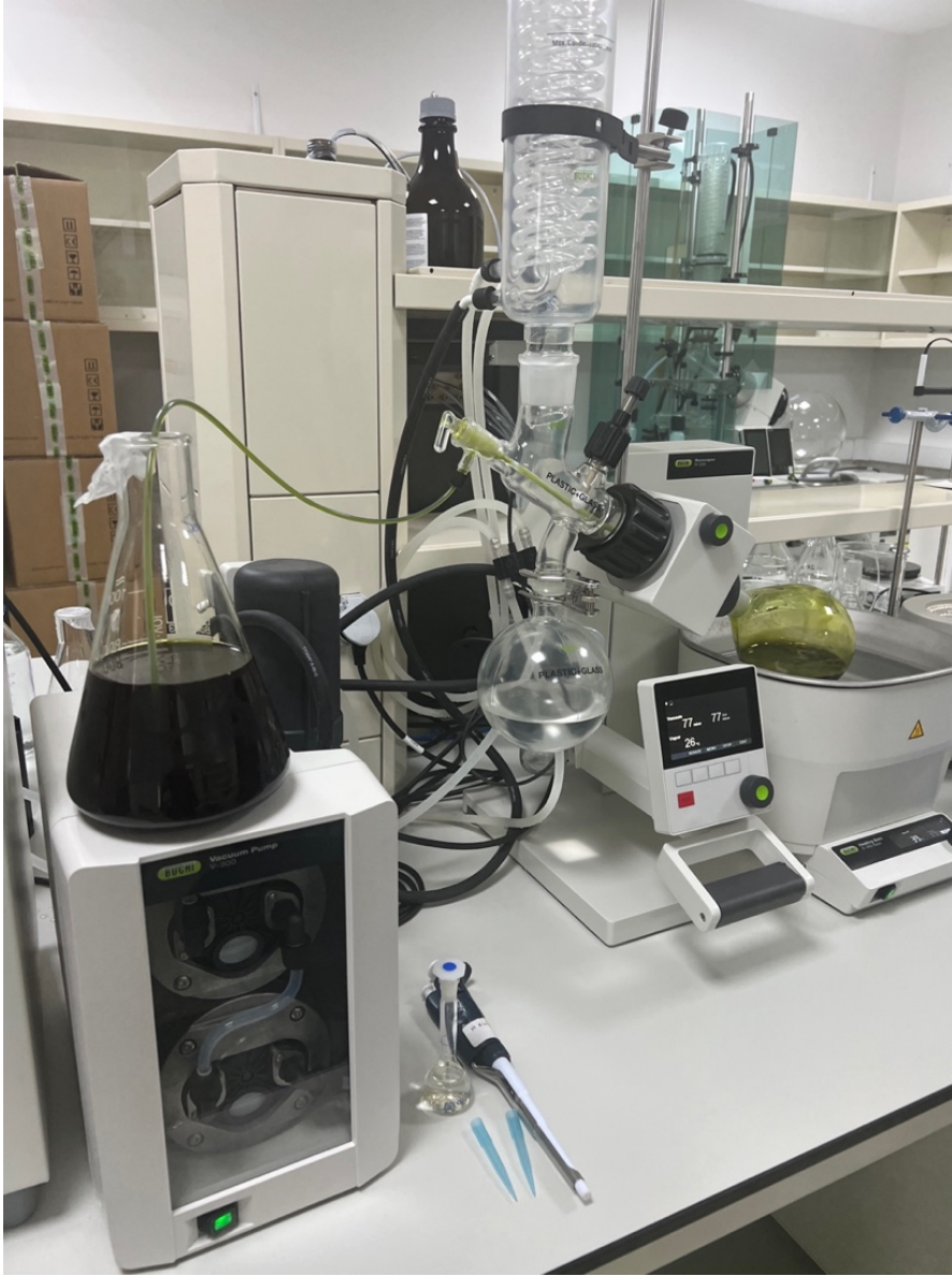
Şekil 3.11: Karadut - etanol karışımının ekstre oluşumu için rotavapor cihazına (Büchi R-300) aktarılması
