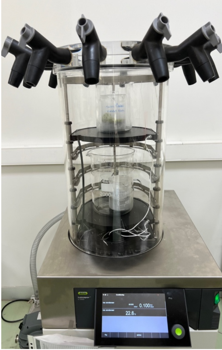
Şekil 3.14: %100 karadut ekstresi formunda toz elde etmek amacıyla liyofilizatörde (Büchi L-200) 2 hafta bekletilen donmuş ürün
