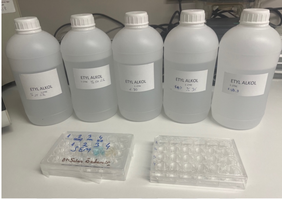
Şekil 3.37: Fiksasyon işlemi yapılan dentin disklerinin dehidrate edilmesi
