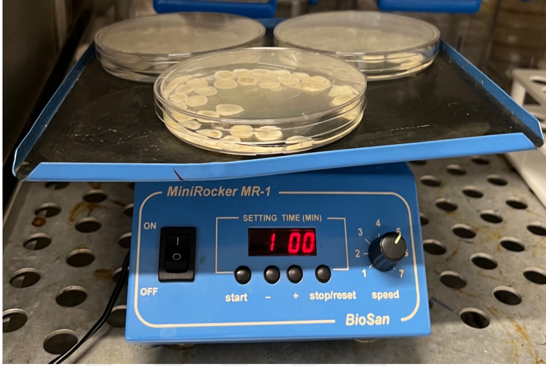
Şekil 3.25: Pelikül oluşumu için tükürük eklenmiş petri kapları çalkalayıcıda 37 °C’de 1 saat boyunca inkübe edilmesi
