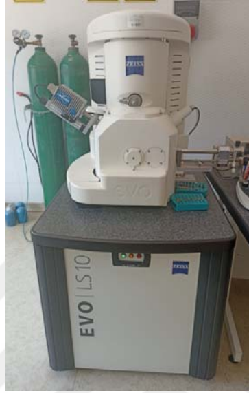
Şekil 4.7. Taramalı Elektron Mikroskobu (SEM) Zeiss Evo LS10 Cihazı (SÜ, İLTEK laboratuvar)
