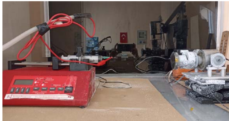
Şekil 3. 12 Deneyde kullanılan elektroeğirme düzeneği
