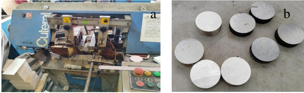
Şekil 7.2. a) Numunelerin kesildiği şerit testere tezgâhı b) Al7075 T6 ve AISI4140 çelik numuneler
