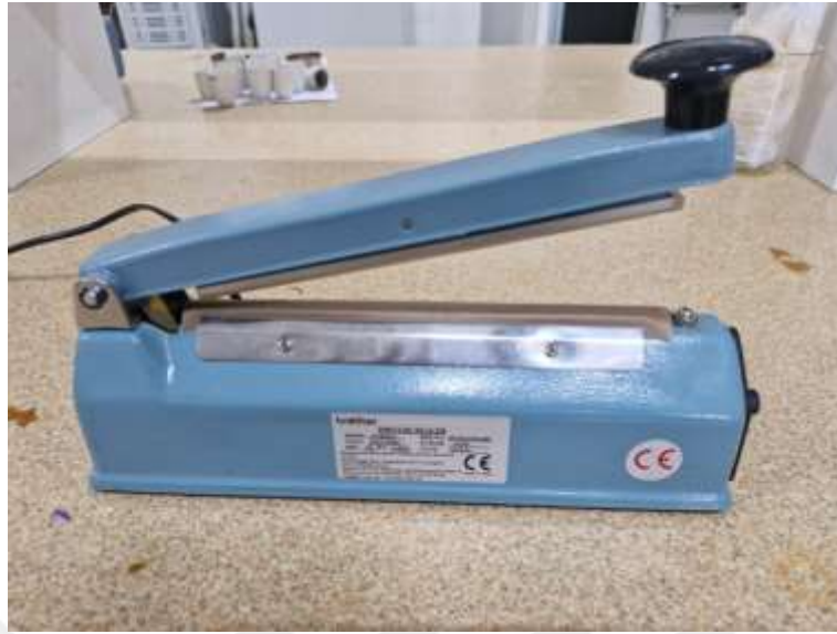
Şekil 7. Filtre Torba Ağızı Mühürleme Cihazı
