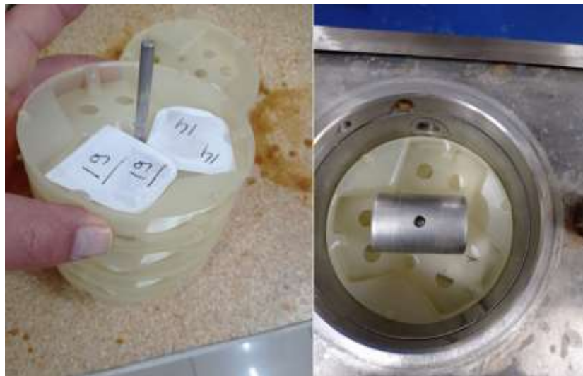
Şekil 9. NDF, ADF, ADL Analizinde Materyalin Cihaza Yerleştirilmesi
