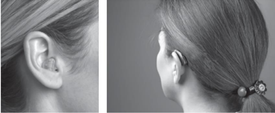
Şekil 7. Bir işitme cihazı kullanıcısı tarafından takıldığı şekliyle kulak içi (ITE) ve kulak arkası (BTE) işitme cihaz örneği
