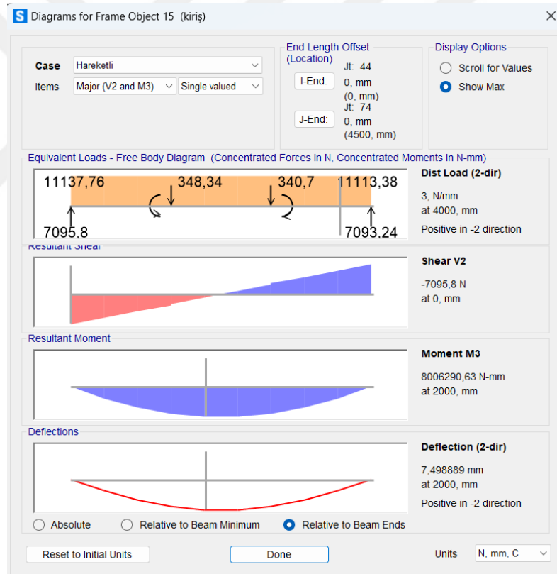
Şekil 4.13. C27 kiriş hareketli yük diyagramı.
