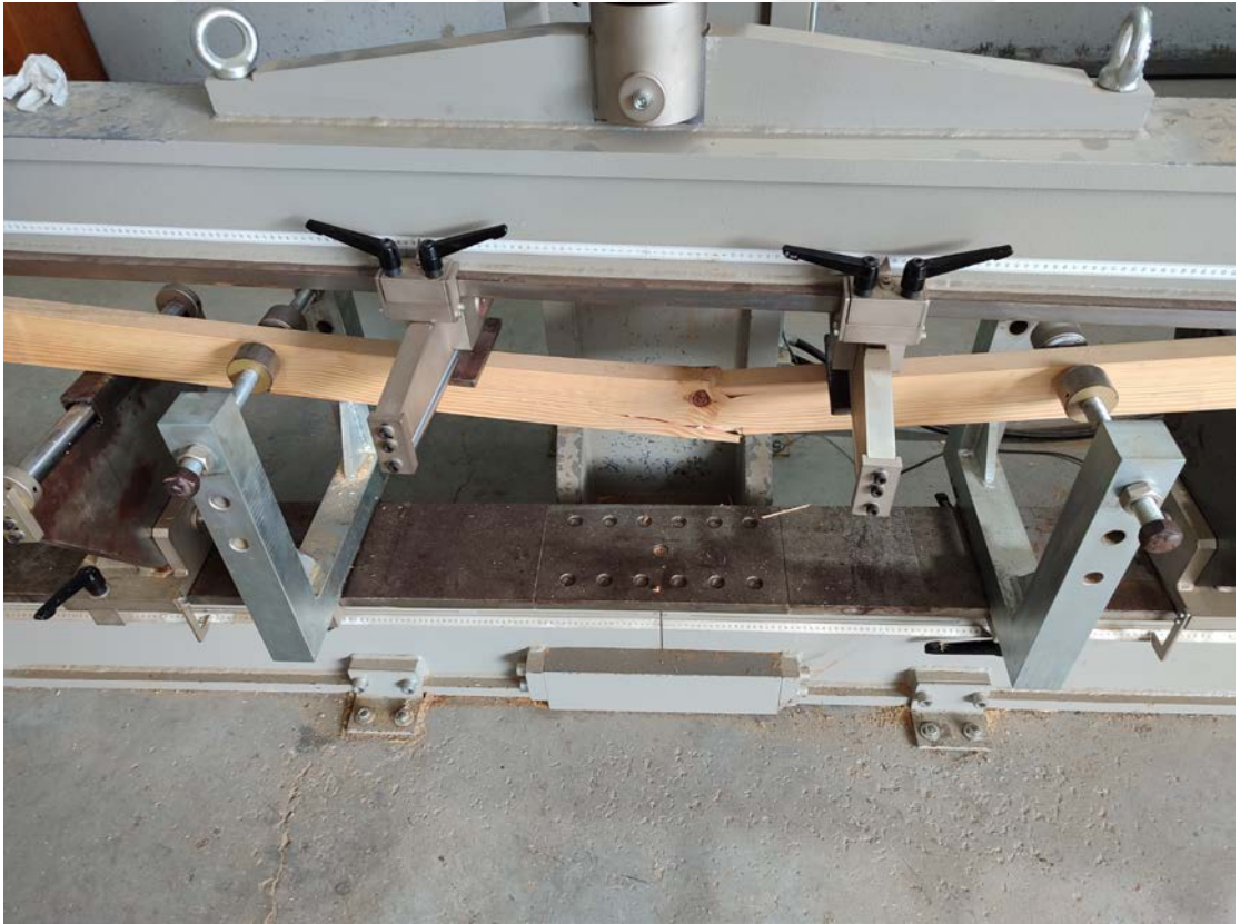
Şekil 3.11. Maksimum yüke ulaşarak kırılan bir test örneği.
