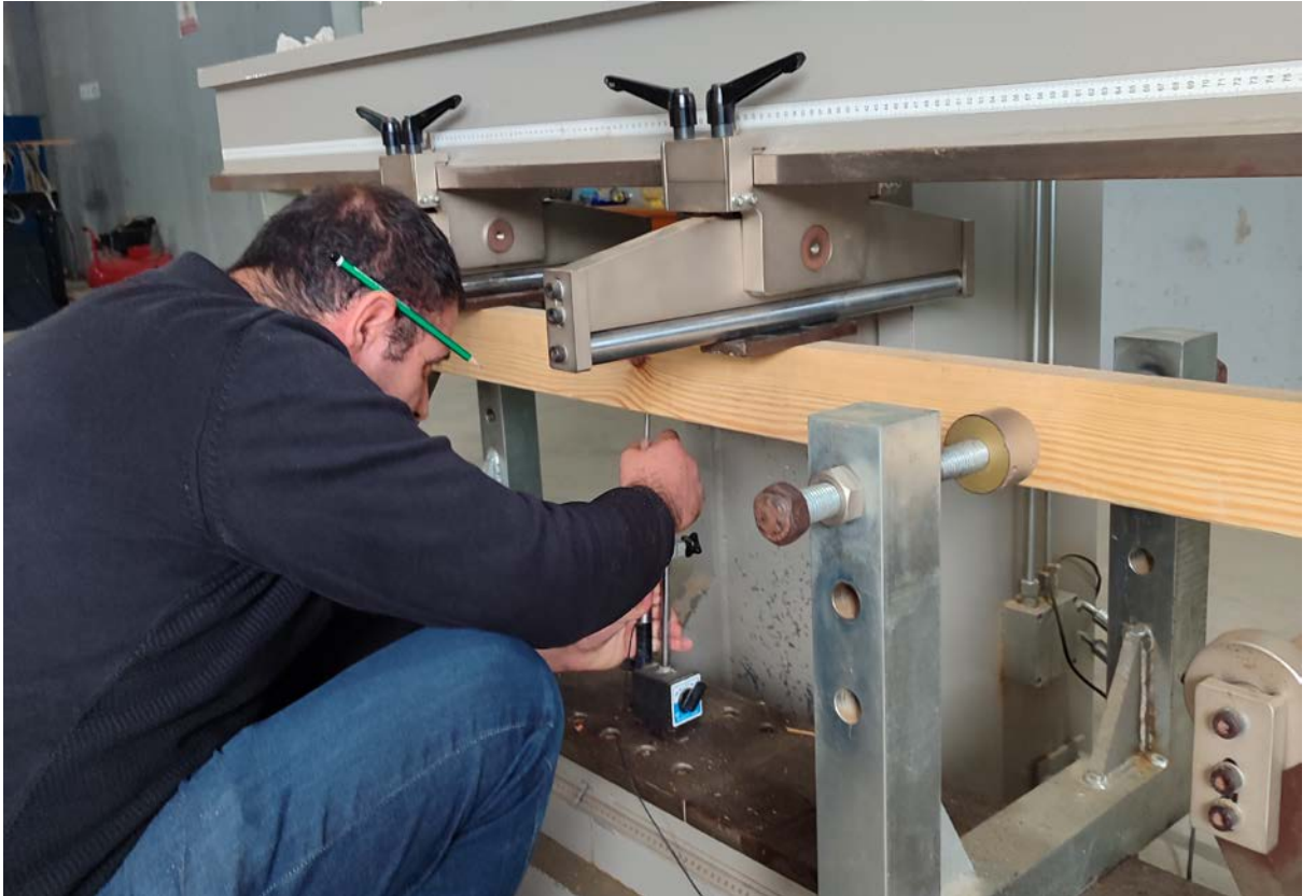
Şekil 3.9. LVDT cihazının test düzeneğinden kaldırılması.
