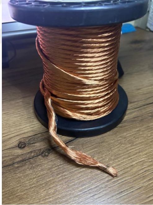
Şekil 4.1 Primer ve sekonder sargılar için üretilen 1200 \times 0.1 mm litz teli.
