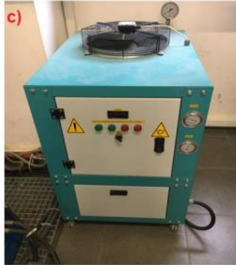
Şekil 2.9 : Vakum ergitme ve döküm sistemi (a) vakum kabini, (b) indüksiyon ergitme ocağı, (c) su soğutma ünitesi.
