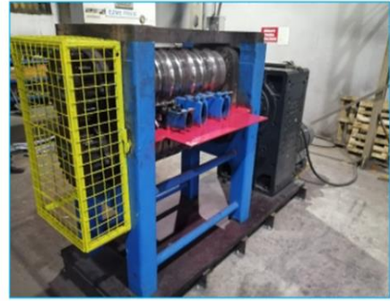
Şekil 2.16 : Sıcak deformasyon işlemlerinde kullanılan haddeme fiziksel simülatörü. Belirtilen ölçülerdeki ham malzemeler kullanılarak tasarlanan ürün formunda üretimler yapabilmek adına Şekil 2.17’de paylaşılan sıcak dövme kalıpları kullanılmıştır.
