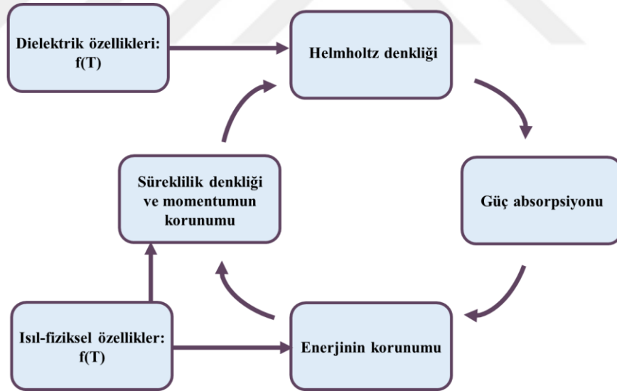
Şekil 3.7 Matematiksel model geliştirme çalışması için elektromanyetik alan, sıcaklık ve akış denkliklerinin eş zamanlı çözülmesi kapsamında uygulanan yaklaşım (Topcam vd. 2020)
