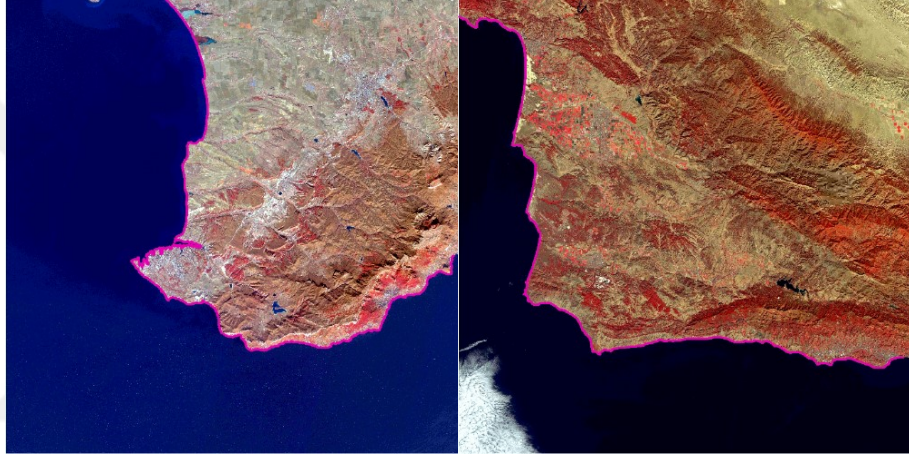
Şekil 4.16 Kırım (sol) ve ABD (sağ) test görüntüleri için çıkartılan kıyı çizgileri
