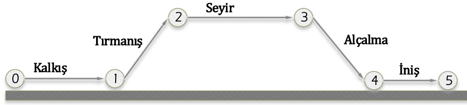
Şekil 2.4. Bir quadkopter için genel uçuş profili [48]
