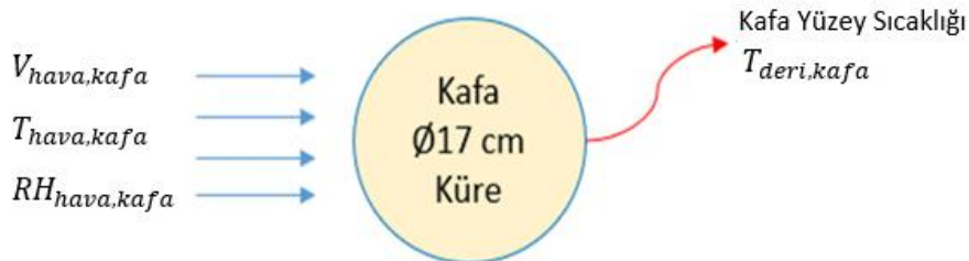
Şekil 4.3 Kafa Üzerinde Şartlandırılmış Hava Akışı
