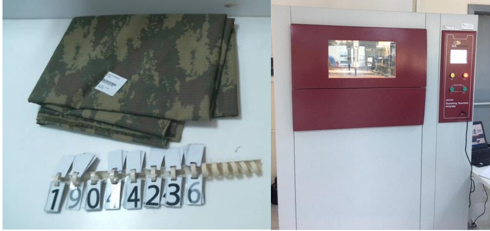
Şekil 2.13 Orijinal askeri üniforma test numunesi ve SDL ATLAS M259B test cihazı
