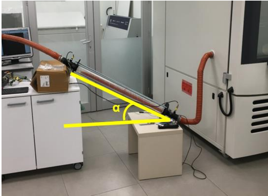
Şekil 5.34 Eğimli yerleşimde silika jel kitinin eğim açısının gösterimi
