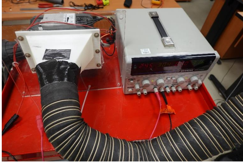
Şekil 4.17 Deney düzeneğinde hava emiş motoru ve DC güç kaynağı
