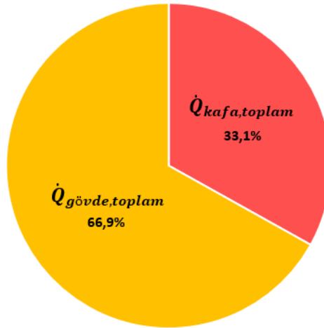
Şekil 6.4 Personelin tüm vücudu üzerinde gerçekleşen toplam ısı transferine kafa ve gövde üzerinde gerçekleşen ısı transferi miktarlarının oranları
