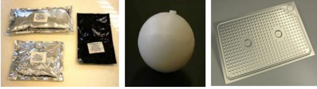
Şekil 6.17 Faz değıştiren malzemelerin farklı şekillerde paketlenme örnekleri
