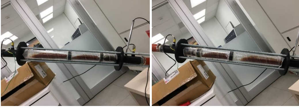
Şekil 5.33 Üç bölge silika jel kiti yerleşimi
