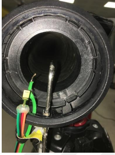
Şekil 4.19 Üfleç çıkışında pitot tüpü ve sıcaklık sensörü yerleşimi
