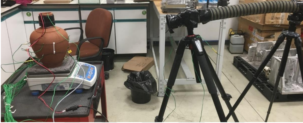
Şekil 5.3 Toprak testinin terleme benzeşimi deney düzeneği
