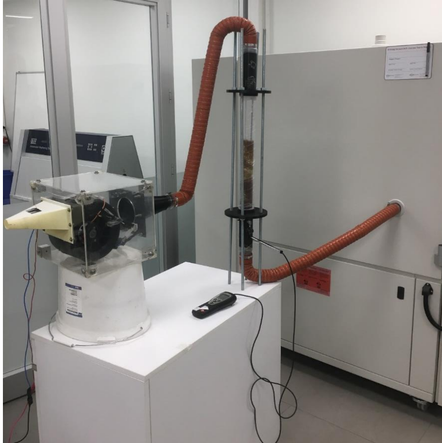
řekil 5.35 Dikey olarak silika jel kitinin pozisyonlanması
