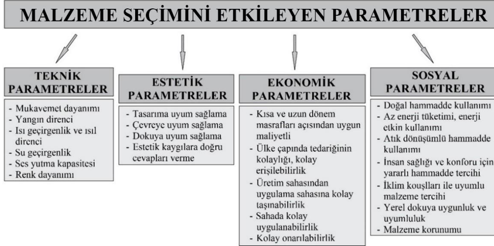
Şekil 4.1 Malzeme seçimini etkileyen parametreler [76]
