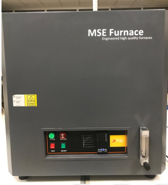
Şekil 2.5. Vakumlu tüp fırın.
