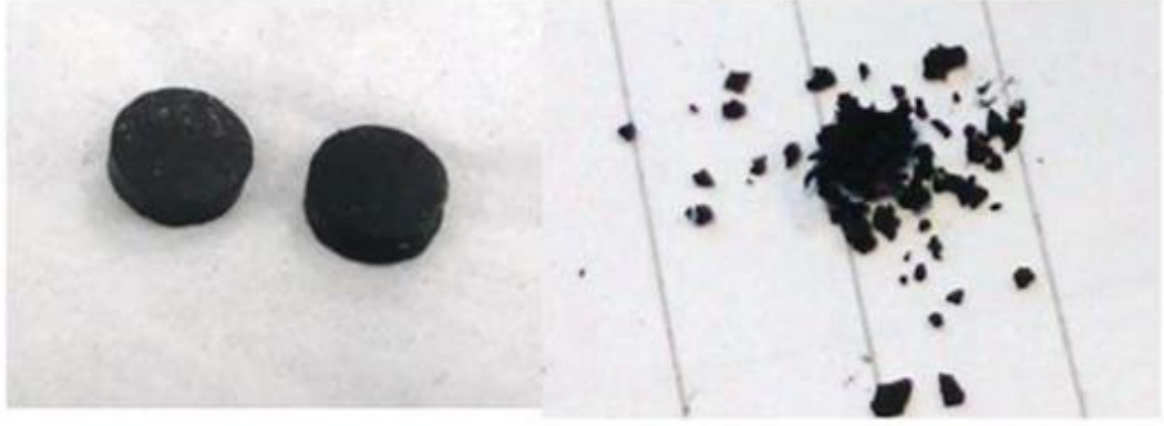
Şekil 42. 24 saat oda sıcaklığında G2 katalizörü varlığında bekleyen, 8 mm x 2 mm SBR örneği.
