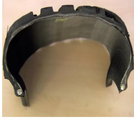
Şekil 36. Vulkanizasyon sonrası lastiğin ara yüzeyi [33].
