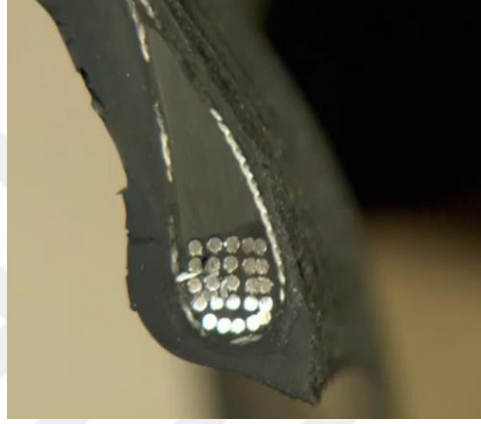
Şekil 37. Vulkanizasyon sonrası lastiğin ara yüzeyi-2.
