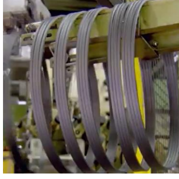
Şekil 33. Kauçuk-Çelik karışımından üretilen kasnak.
