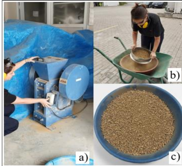
Şekil 3.1 : (a) Zeminin çeneli kırıcıda kırılması, (b) Kil zemin 4 No'lu elekten ayrıştırılıp elenmesi, (c) Pazaryeri kilinin elendikten sonraki genel görünümü.
