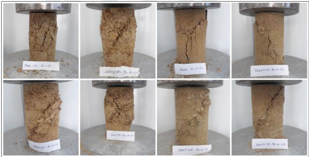
Şekil 4.8 : SKK, SKK0.5F, SKKÇ, SKKÇ0.5F, SKK1.0F, SKK1.5F, SKKÇ1.0F ve SKKÇ1.5F numunelerinin kırım sonrası görüntüleri.
