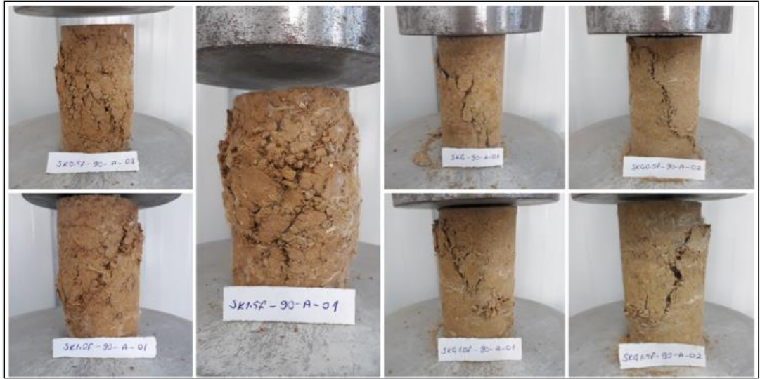
Şekil 4.7 : SK0.5F, SK1.0F, SK1.5F, SKÇ, SKÇ0.5F, SKÇ1.0F ve SKÇ1.5F numunelerinin kırım sonrası görüntüleri.
