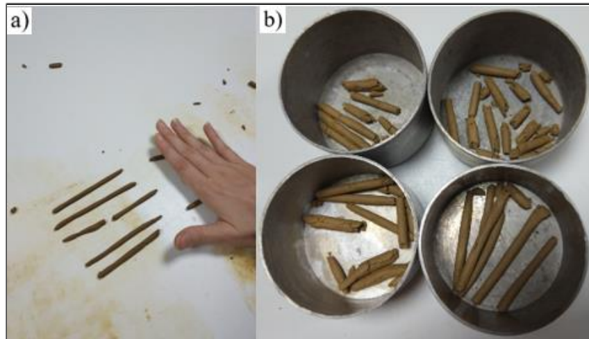
Şekil 3.7 : (a) Numunelerin 3 mm indirme çalışması, (b) çatlaklar oluşan numunelerin kaba alınması.
