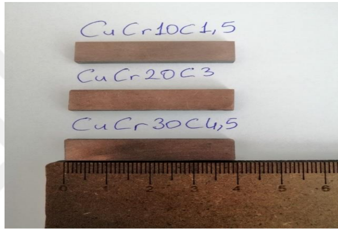
Şekil 6.6. SPS'de 40x10x4 mm ölçülerinde hazırlanan numuneler
