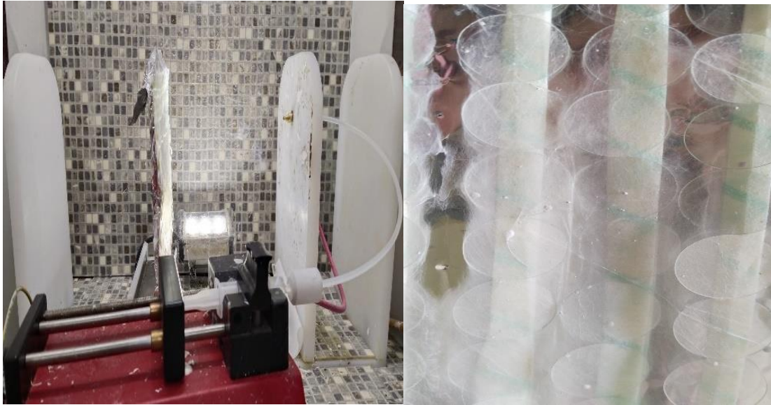
Şekil 3.5. C. botrytis özütünden hazırlanan gümüş nanopartikül katkılı kitosan nanoliflerin hazırlanışı
