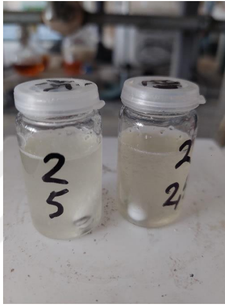
Şekil 3.4. C. botrys özütünden hazırlanan gümüş nanopartikül katkılı kitosan polimer çözeltisi
