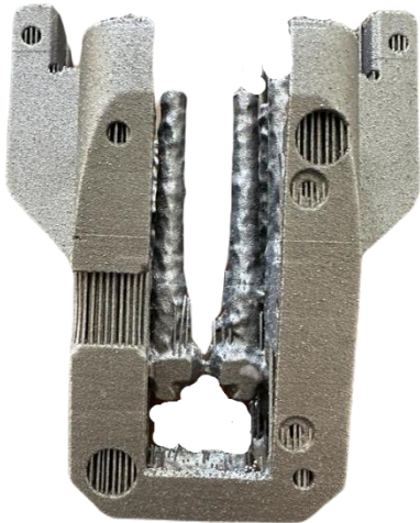
Şekil 3.15 Robot kol parmak tutucusunun destek yapılarının temizlenmesi
