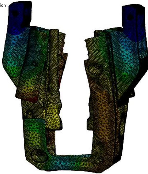
Şekil 4.5 a) Optimizasyon öncesi ve b) optimizasyon sonrası toplam deformasyon değerleri
