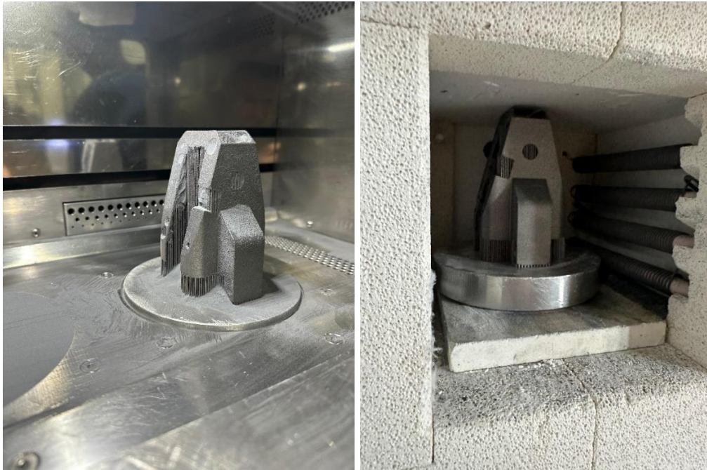
Şekil 4.9 Robot kol parmak tutucusunun SLM ile üretim sonucu ve ısıl işlem için fırına yerleştirilmesi
