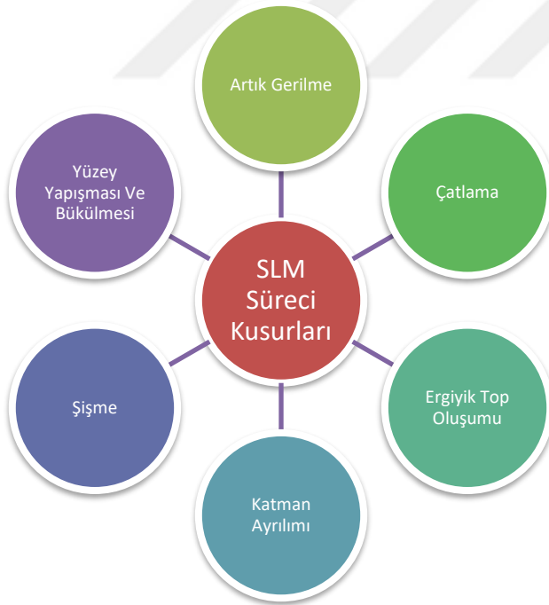
Şekil 2.11 Tipik SLM süreci kusurları [52].
