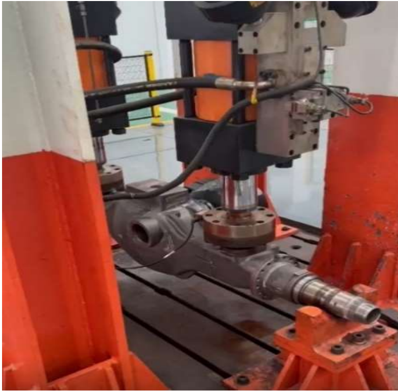
Őekil 2.6: Aks kovanı iin hazırlanmış dikey yorulma test rig dzeneneęi.
