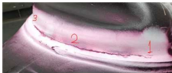
Şekil 2.7: Kovanda oluşan çatlak.
