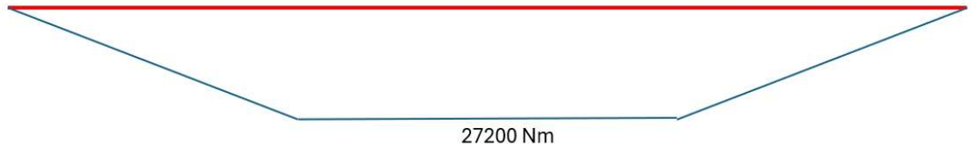
Şekil 3.7: Dikey eğilme kesit tesir diyagramları.
