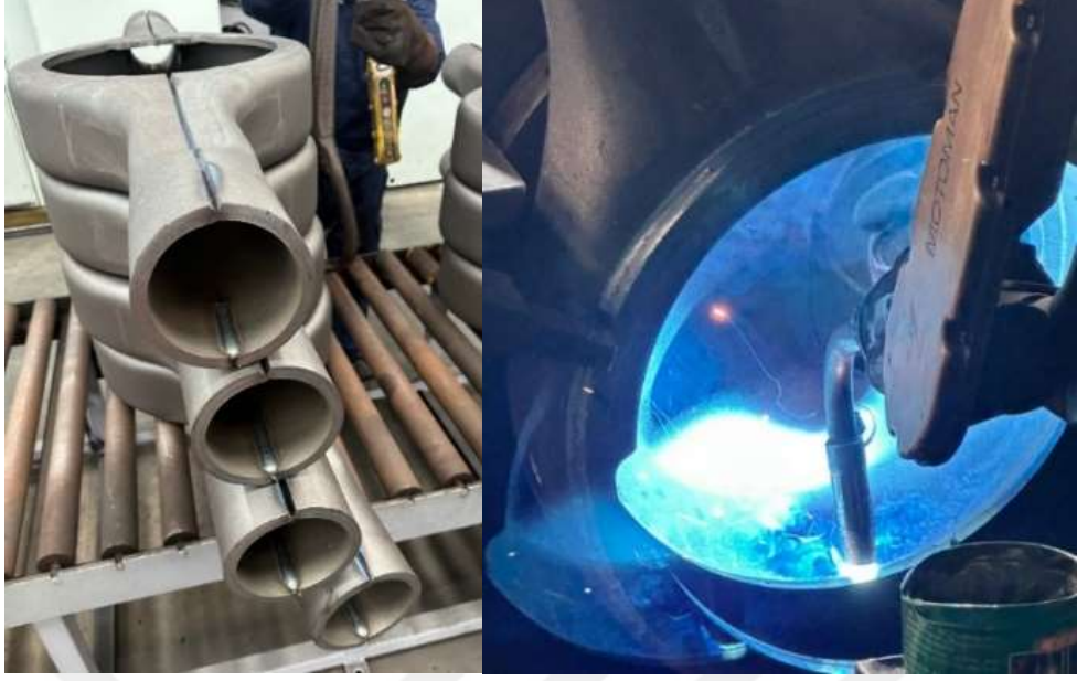
Şekil 1.7: Kaynaklı aks kovani gövdesi imalatı.
