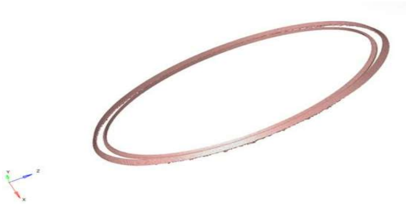
Şekil 3.14: Aks kovanı kaynak dikişi modeli.
