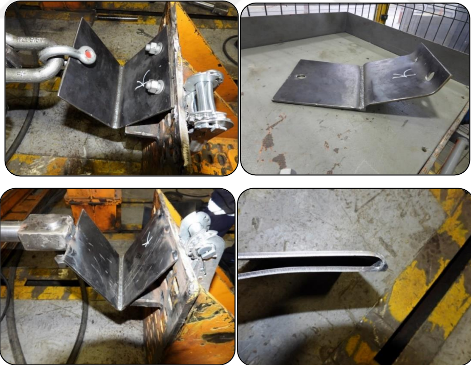
Şekil 5.30. Kaynak Proses İle Üretilmiş “V” Konstrüksiyon Çekme ve Basma Deneyi
