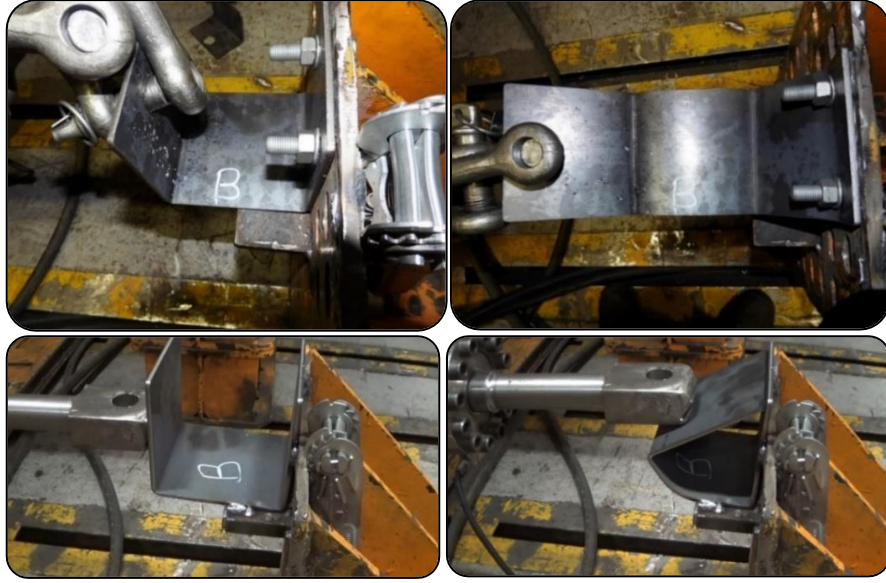
Şekil 5.39. Büküm prosesle üretilmiş “U” parçanın çekme ve basma deneyi.
