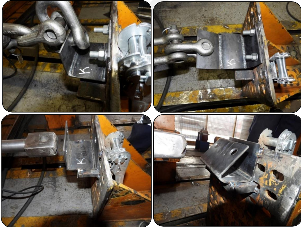
Şekil 5.42. Kaynaklı prosesle üretilmiş “U” parçanın çekme ve basma deneyi.
