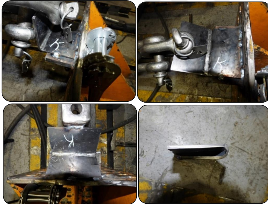
Şekil 5.36. Kaynaklı prosesle üretilmiş “L” parçanın çekme ve basma deneyi.
