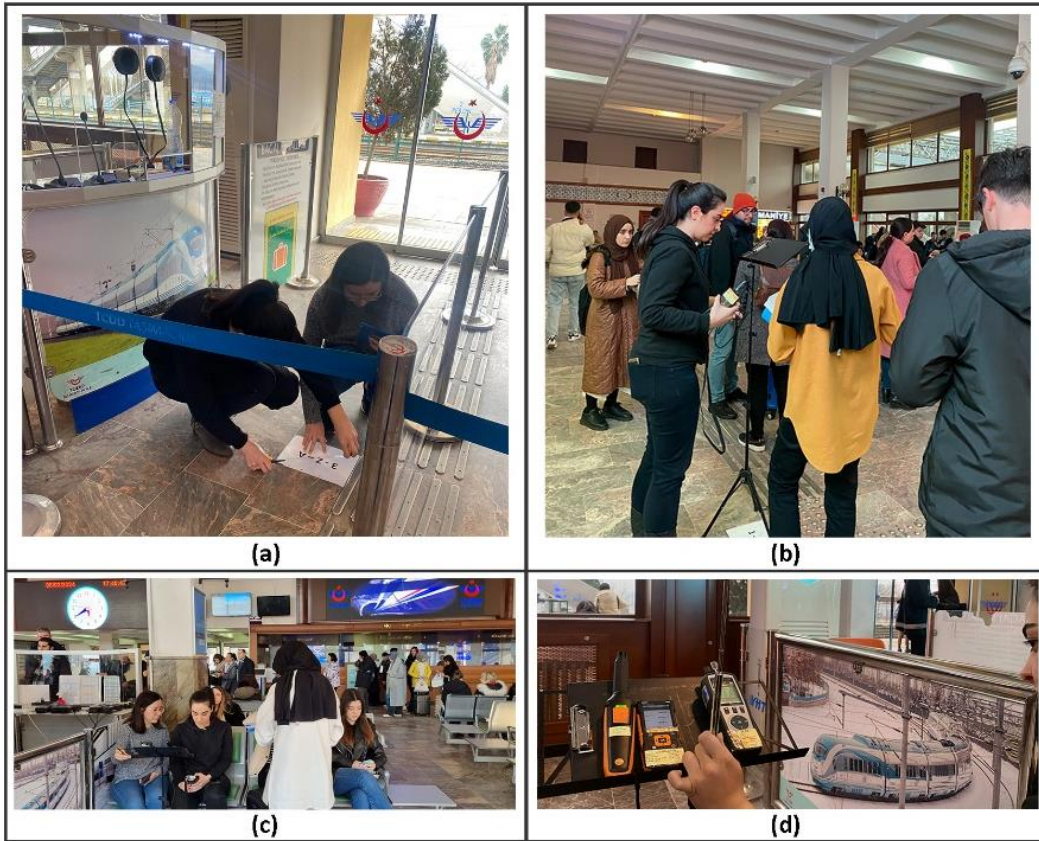
Şekil 4. 12. Ölçüm aşamaları: (a) Kağıtların yapıştırılması, (b) Ölçüm aletlerinin 1.5 metre kotunda konumlandırılması, (c) Ölçüm aletlerinin 1 metre kotunda konumlandırılması, (d) Ölçüm anı
