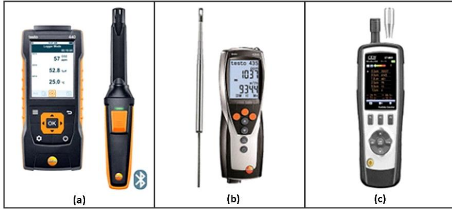
Şekil 4. 11. Ölçümde kullanılan aletler: (a) Testo 440 CO 2 ölçer, (b) Testo 435 hava hızı ölçer, (c) Cem DT-9880 PM ölçer
