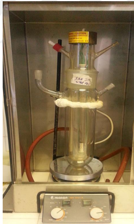
Şekil 3.3. Deneysel çalışmalarda kullanılan UV reaktörü ve şematik görünümü.
