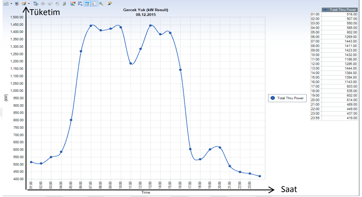
Şekil 5.2 : OSOS Transformatör günlük gerçek yük profili.
