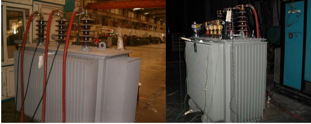
Resim 7.1. Serbest ortamda yapılan sıcaklık artışı deneleriyle ilgili örnekler
