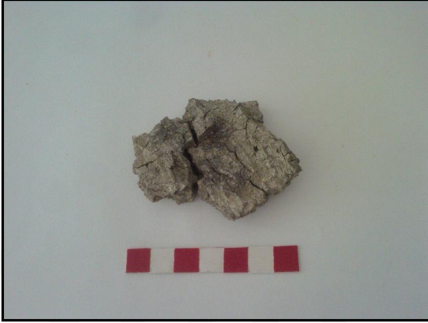
Resim 46. Tez Çalışmasındaki Fırın Sıvası.
