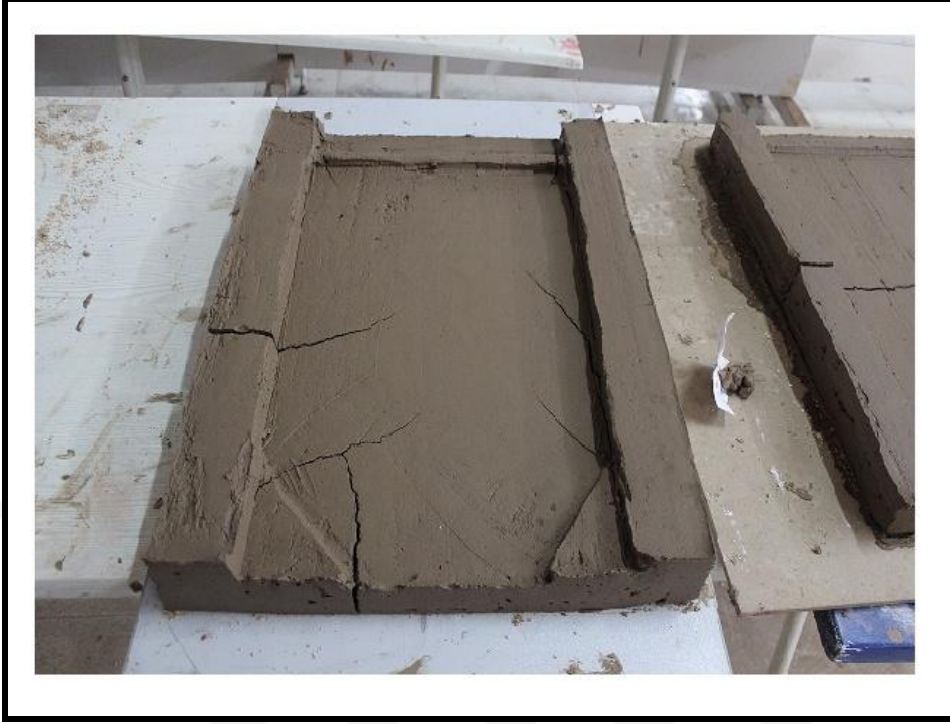
Resim 112. Korint Kiremitin Kuruma Sonrası Çatlamaları.
