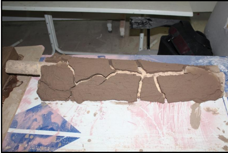
Resim 108. Kalıpta Çatlamalar (Kumluca Kili).
