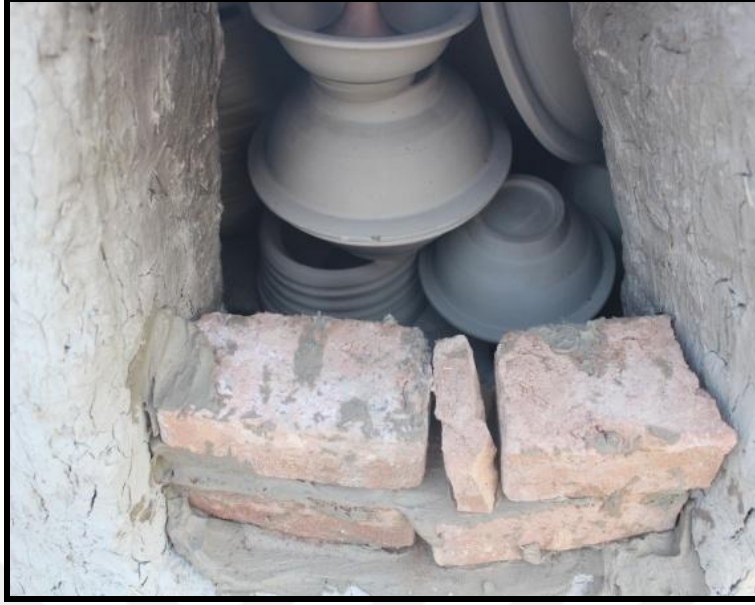
Resim 116. Ürün Besleme Penceresinin Tuğlalarla Kapatılması.
