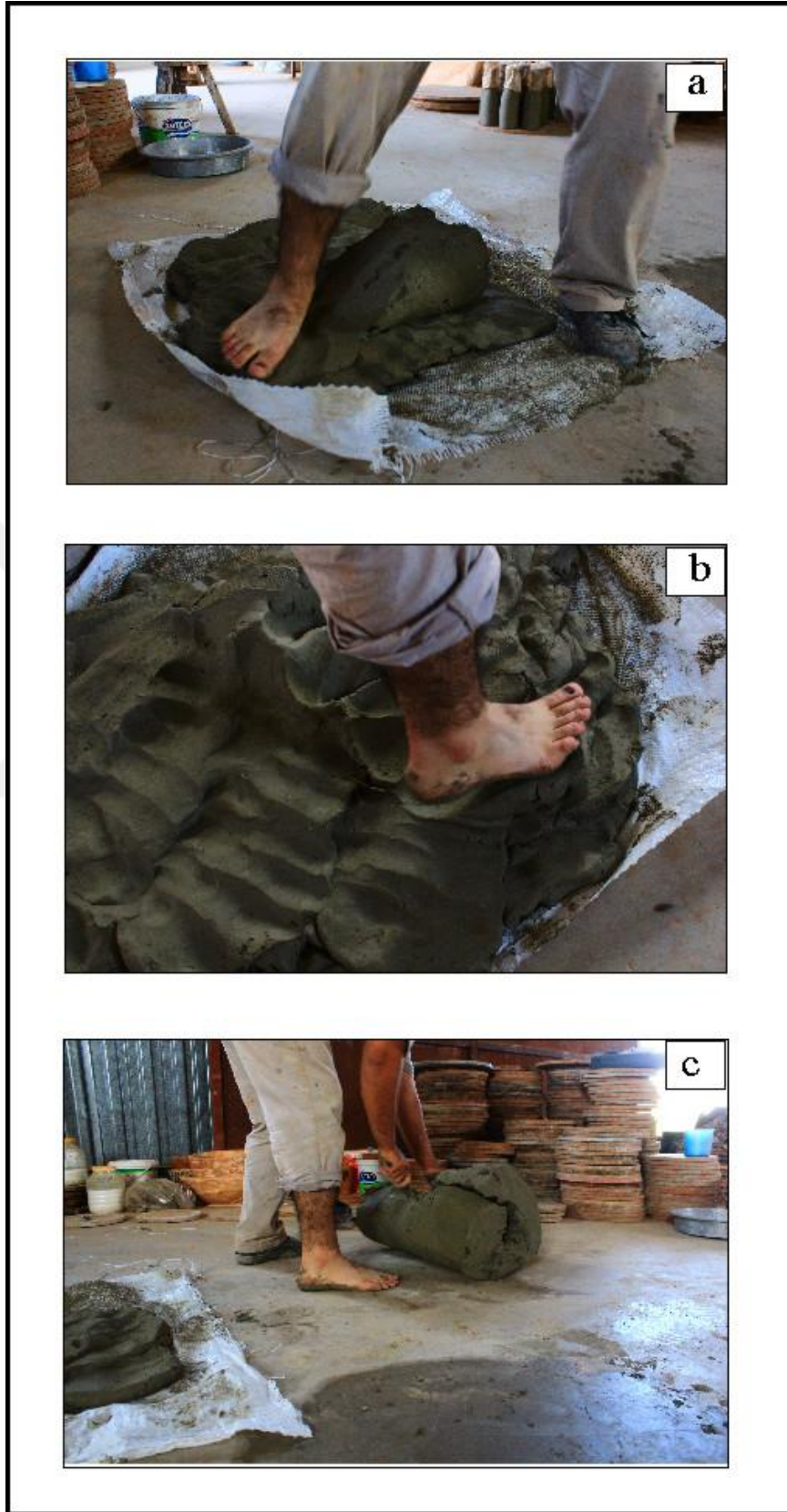
Resim 96. amurun Ayak ile Yoęrulması.
