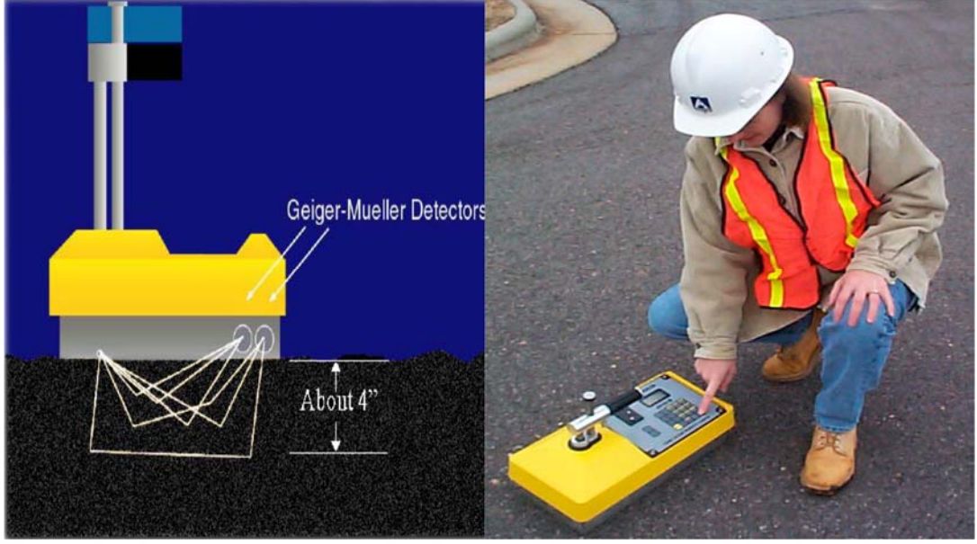
Şekil 4.18. Üstyapıda nükleer yoğunluk ölçümü (Williams, 2008)
