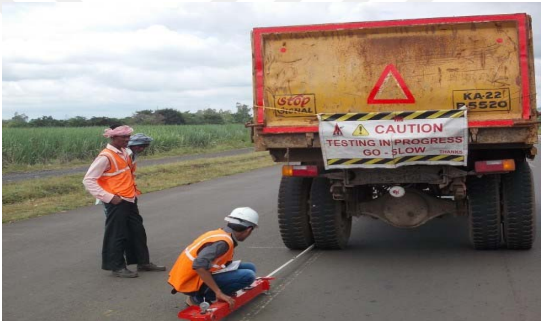
Şekil 4.2. Esnek üstyapılar için benkelman kirişi uygulaması
