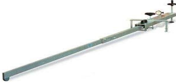
Şekil 4.1. Benkelman kiriş aleti
