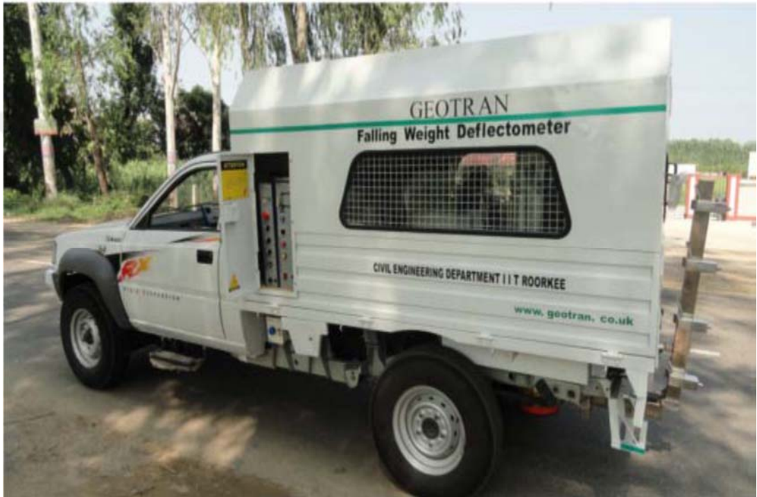
Şekil 5,9. Geotran düşen ağırlıklı deflektometre
