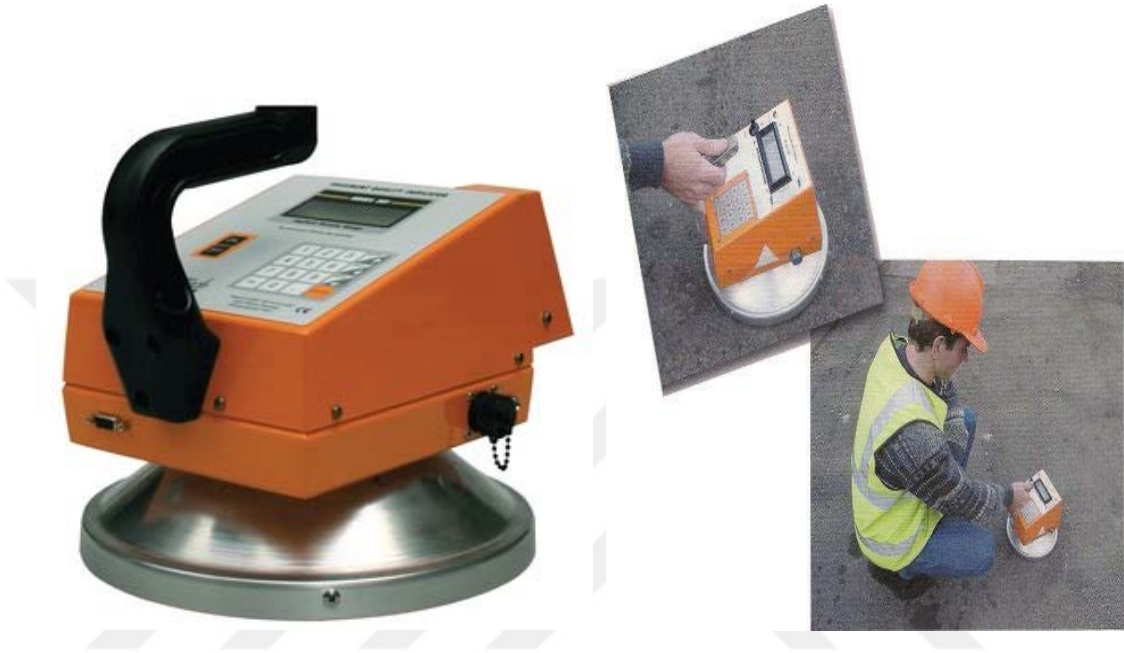
Şekil 4.20. PQI deney aleti
