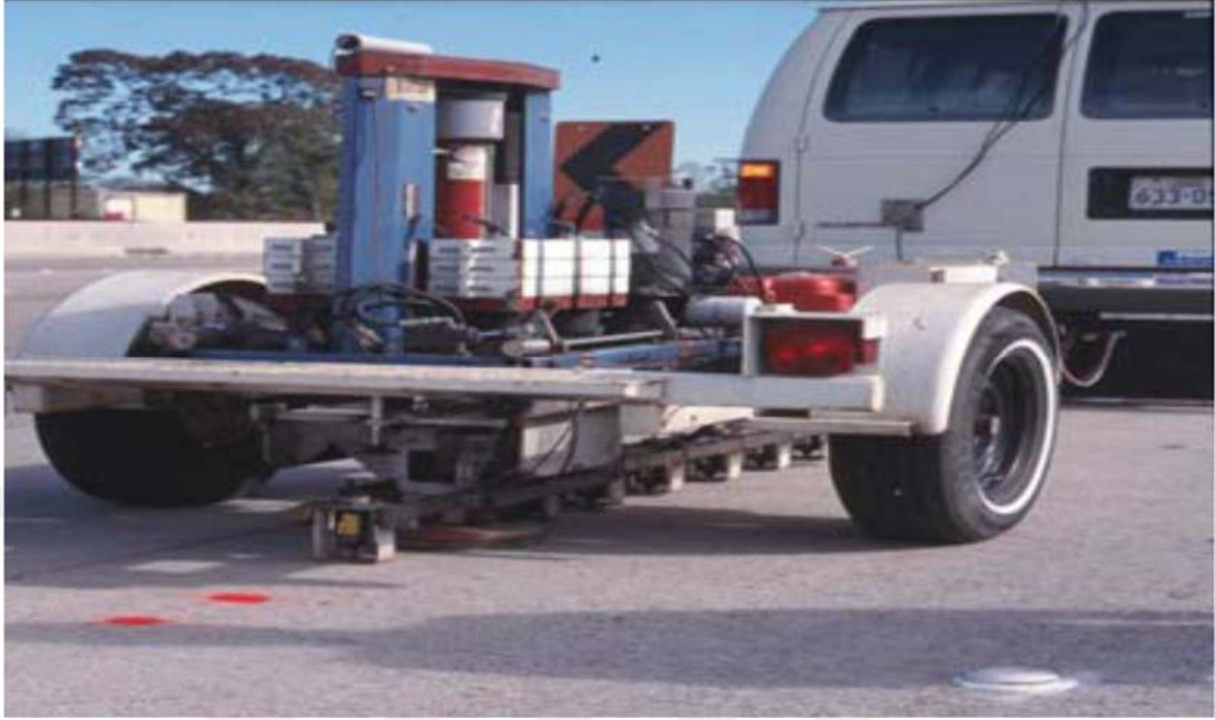
Şekil 4.11.Düşen Ağırlıklı Deflektometre aleti
