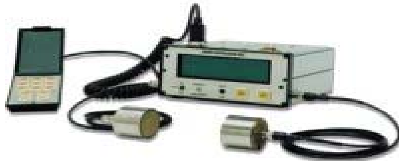
Şekil 4.29. Ultrases geçiş hızı cihazı
