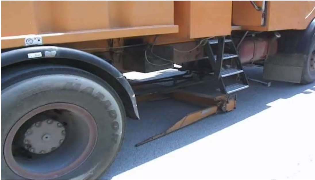
Şekil 4.4. Esnek üstyapılar için La Croix Deflectograph uygulaması
