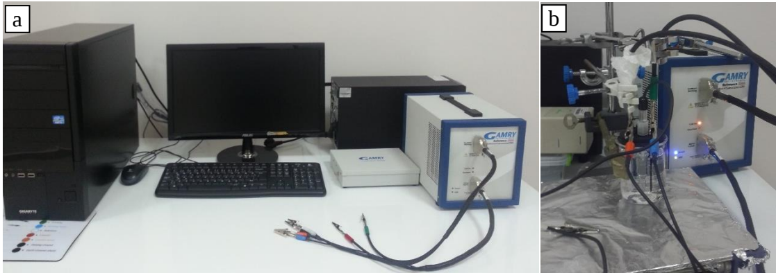
Şekil 4.2. (a) Gamry Reference 3000 potansiyostat cihazı ve (b) üç elektrotlu test hücresi
