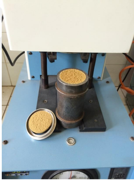
Şekil 4.14 : Döküm kumu için standart numuneler üzerinde gerçekleştirilen yaş çekme testi sonucu numunenin görünümü.
