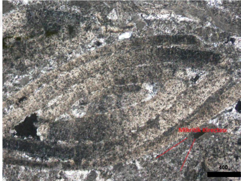
Şekil 3.3 : Fosilli kireçtaşı'nın polarizan petrografik mikroskopta tek nikolde görüntüleri.
