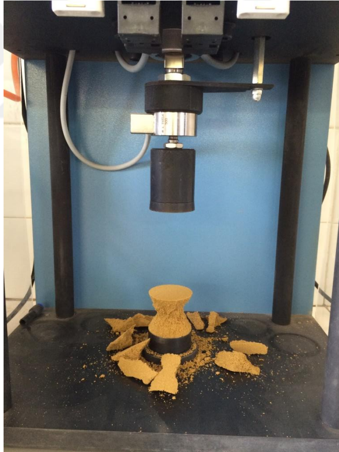
Şekil 4.9 : Döküm kumu için standart numuneler üzerinde gerçekleştirilen yaş basma testi sonucu numunenin görünümü.
