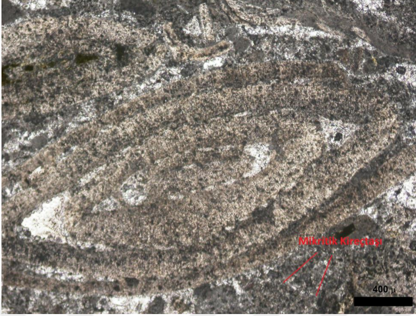
Şekil 3.4 : Fosilli kireçtaşı'nın polarizan petrografik mikroskopta çift nikolde görüntüleri.
