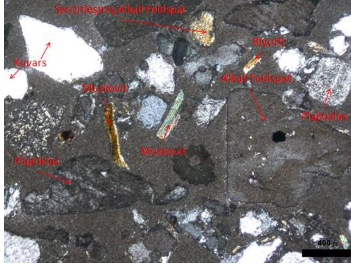
Şekil 3.6 : Gri kum polarizan petrografik mikroskopta tek nikolde görüntüleri.
