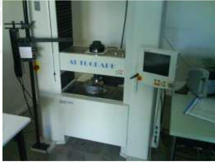
Şekil 5.7.3.4. Schimadzu Autograph 100 kN çekme-basma cihazı.
