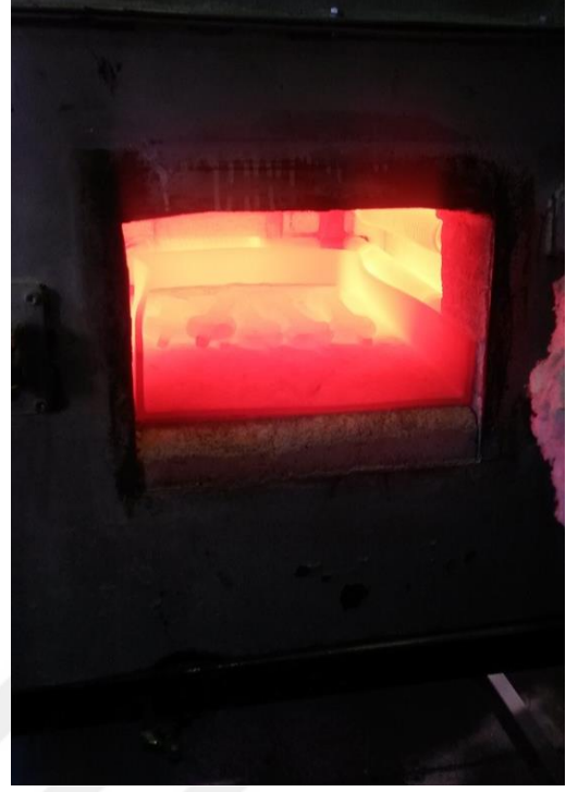
Şekil 5.3.2.1. Dövme presi (Lasco 1600kg). Şekil 5.3.2.2. Fırında ısıtılan ön şekillendirilmiş numuneler.
