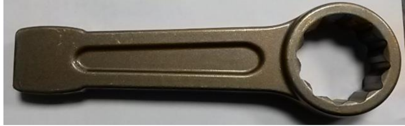
Şekil 5.4.1. Çapağı alınmış, yıldız broşu çekilmiş, yıldız çakma anahtarlar.
