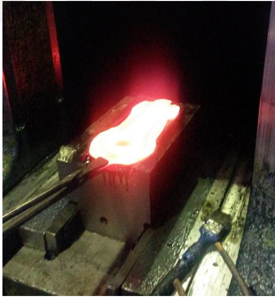
Şekil 5.3.2.3. Kapalı kalıpta sıcak dövme.
