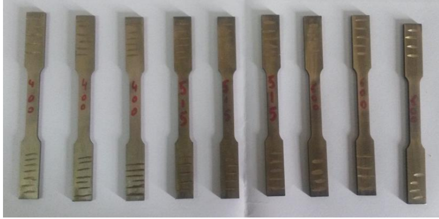
Şekil 5.7.3.5. Çekme testi test numuneleri.
