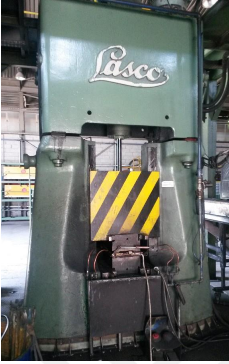
Şekil 5.3.2.1. Dövme presi (Lasco 1600kg). Şekil 5.3.2.2. Fırında ısıtılan ön şekillendirilmiş numuneler.
