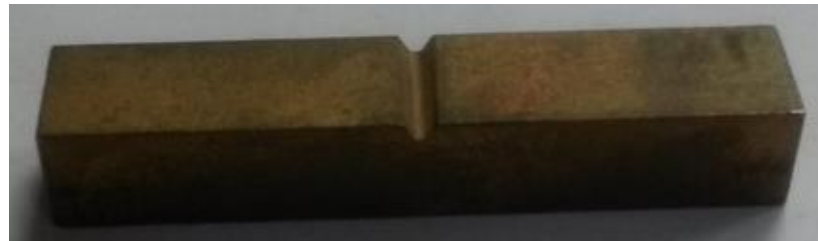
Şekil 5.7.3.2. Çentik darbe V çentik test numunesi.
