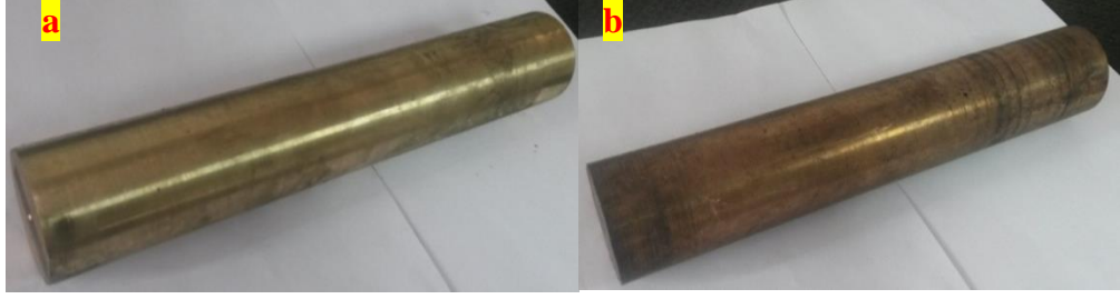
Şekil 5.1.1. a) Alüminyum bronzu yuvarlak malzeme b) Berilyum bronzu yuvarlak malzeme.
