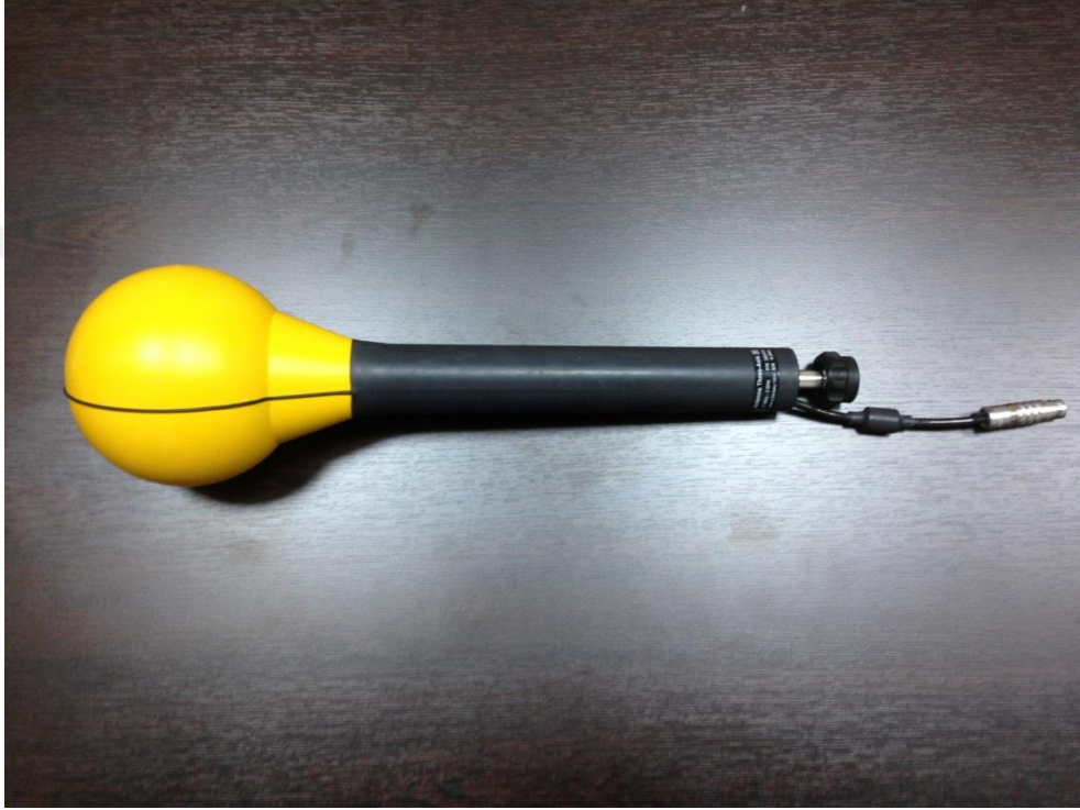
Şekil 3.2. Üç eksenli elektrik alan anteni
