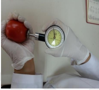
Şekil 3.10. Meyve sertliği penetrometreyle ölçümü.
