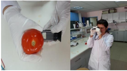
Şekil 3.9. Refraktometre ile Brix ölçümü.
