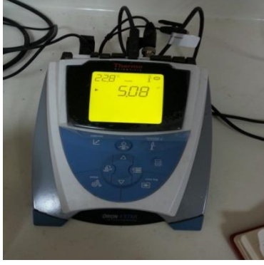
Şekil 3.8. Domates meyvelerinin pH metre ile ölçümü.
