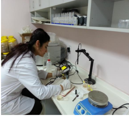
Şekil 3.7. Domates meyvelerinin EC metre ile ölçülmesi.
