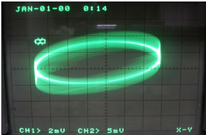
Şekil 6.45. Giriş sinyali-hakim devre xy görünümü (153.3 kHz, 8.16 V)
