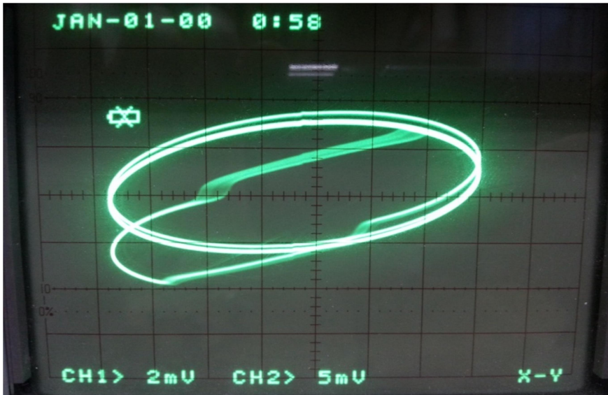
Şekil 6.41. Giriş sinyali-hakim devre xy görünümü (144.3 kHz, 8.16 V)
